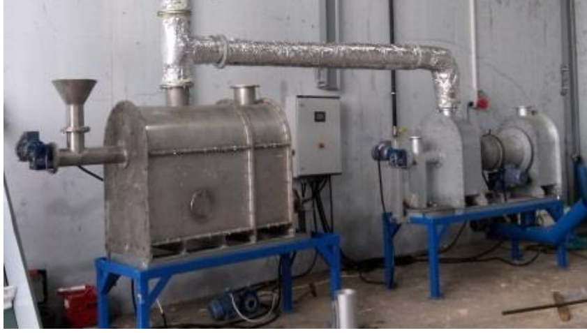
Şekil 5.6. Kurutucu ve piroliz ünitelerinin montajlanmış yerleşimi.
