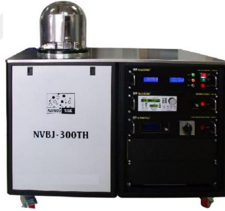
Şekil 3.1. Omik ve doğrultucu kontak oluşturulurken kullanılan metal buharlaştırma cihazı.
