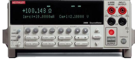
Şekil 3.8. Keithley 2400 Akım-Gerilim Kaynağı.
