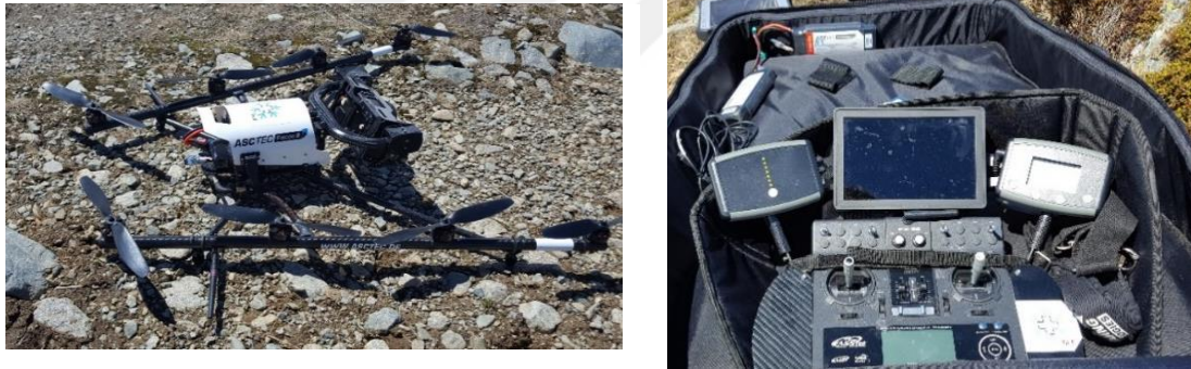
Şekil 2.9. AscTec Falcon 8 multikopter (solda); yer control istasyonu (sağda).
