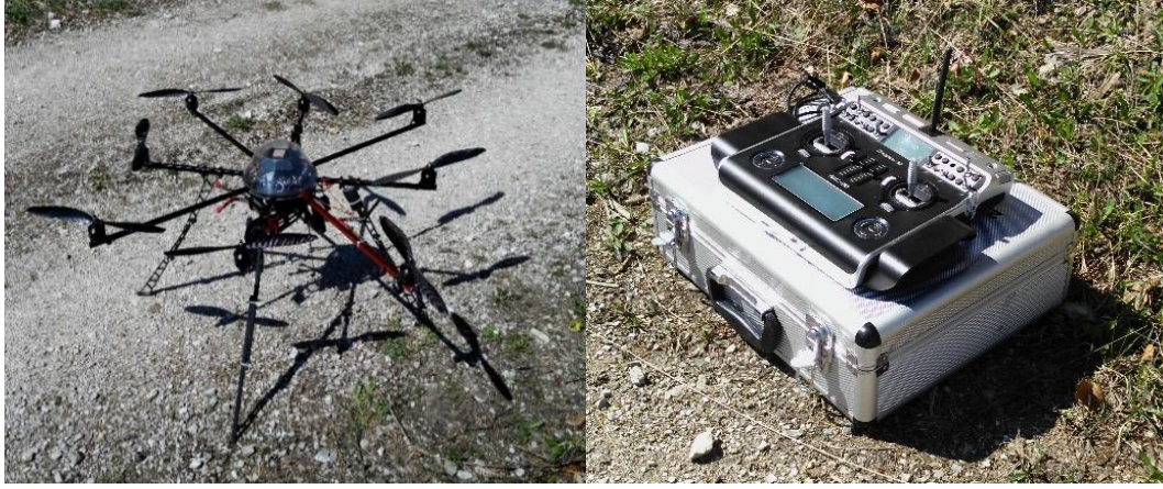
Şekil 2.7. MikroKopter OktoXL İHA (solda), uzaktan kumanda ve yer kontrol ünitesi (sağda).
