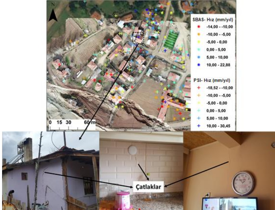
Harita 3.26. Heyelan bölgesinde interferometrik zaman serileri analizi sonucu elde edilen deformasyonların arazideki durumları.
