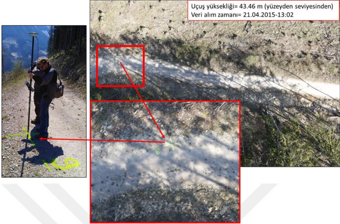
Şekil 2.6. RTK-GPS ile alınan YKN ve fotoğraf üzerindeki görüntüsü.
