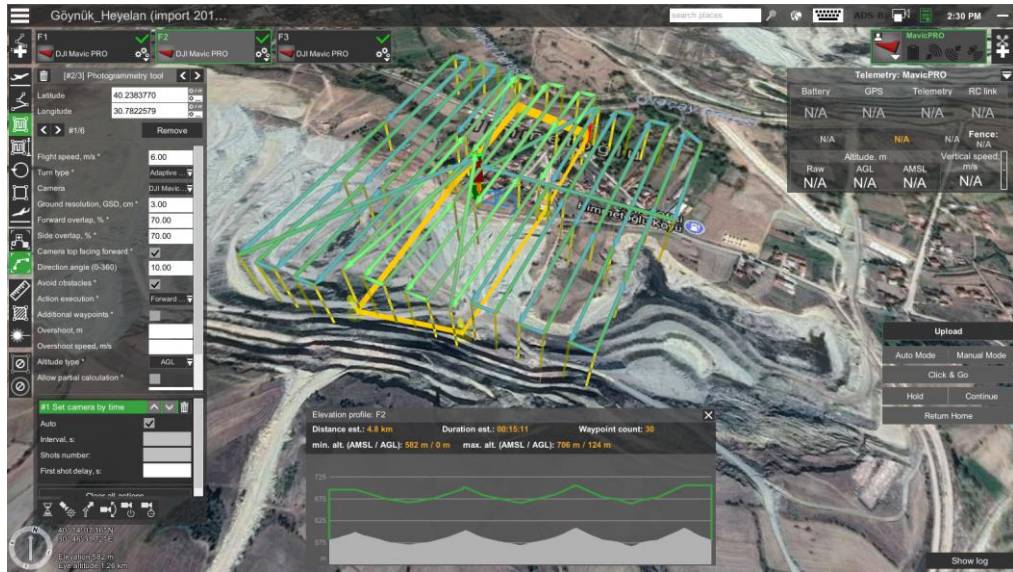
Şekil 2.15. Himmetoğlu köyü heyelan alanında gerçekleştirilen İHA uçuşuna ait uçuş planı görüntüsü
