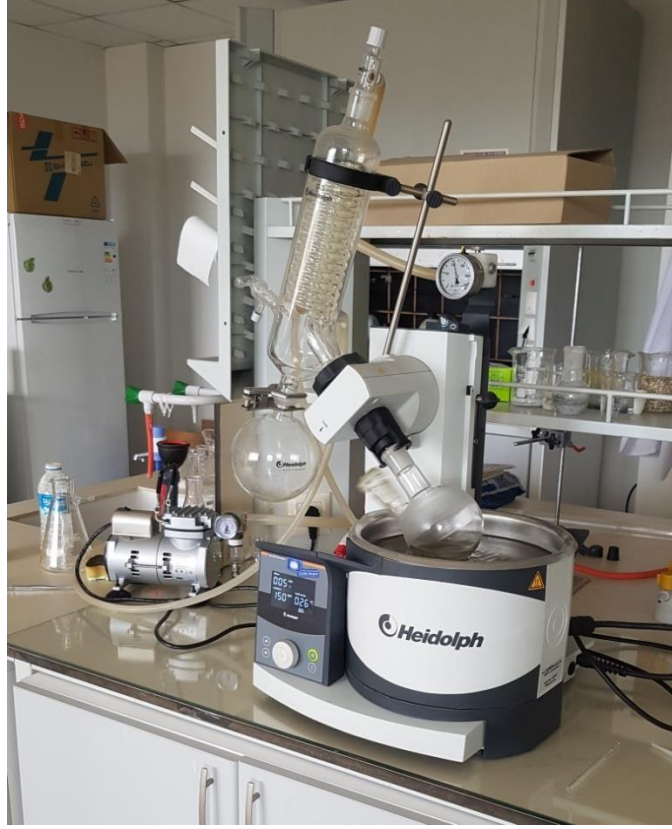
Şekil 2.3. Rotary evaparatörde eterin uzaklaştırılması.
