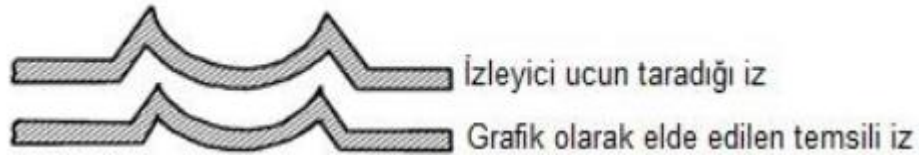
Şekil 4.10. İzleyici uçtan kaynaklanan ölçüm hatası [88].
