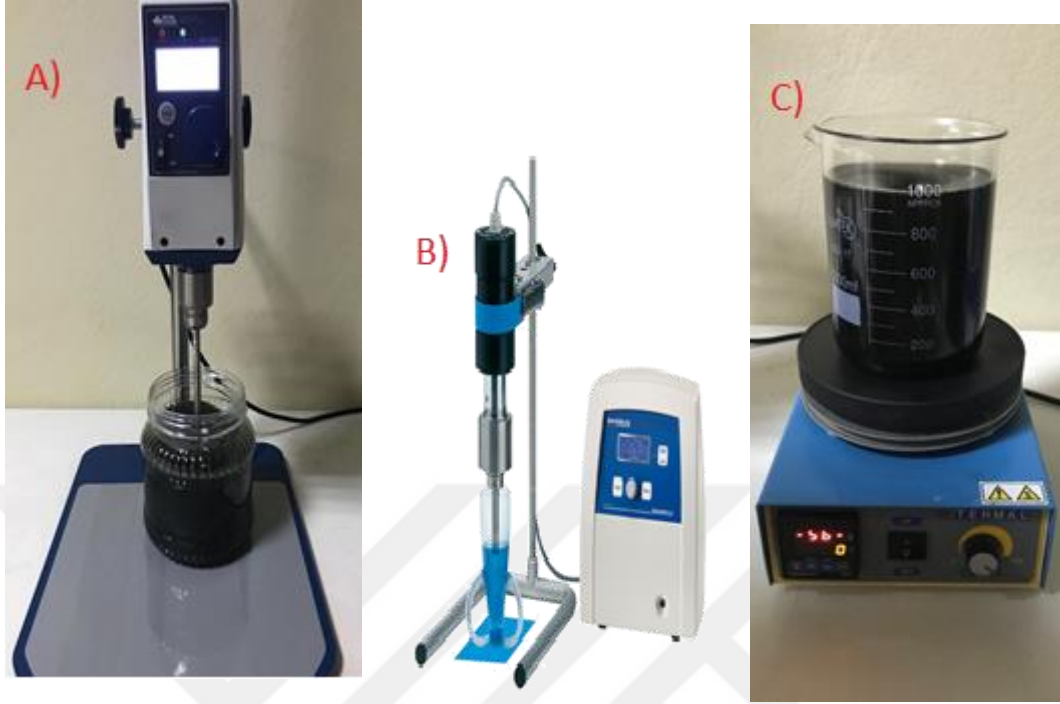
Şekil 8.5. Nano akışkanların hazırlanmasında kullanılan cihazlar a) HS-100D Mekanik karıştırıcı b) Bandelin Sonoplus UW-3200 ultrasonik homojenizatör c) Termal N11150 manyetik karıştırıcı
