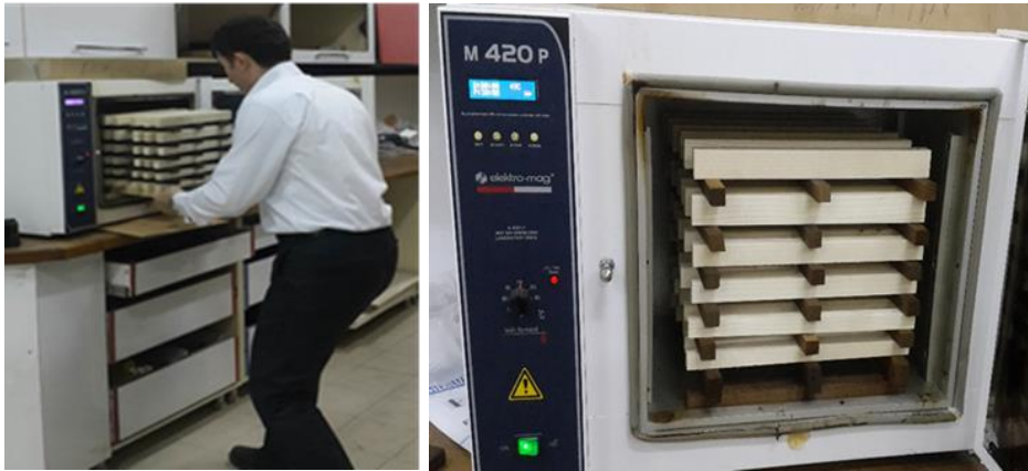
Şekil 4.3. Örneklerin etüv cihazına yerleştirilmesi.
