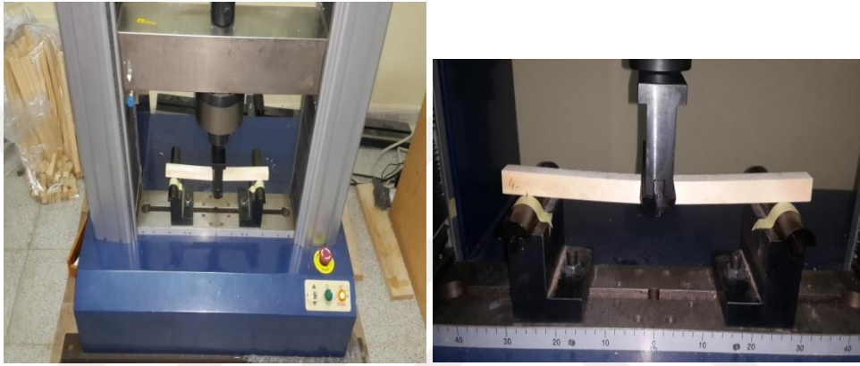
Şekil 4.11. Statik eğilme direnci testi.
