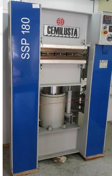
Şekil 4.4. Yoğunlaştırma işlemlerinde kullanılan test presi.
