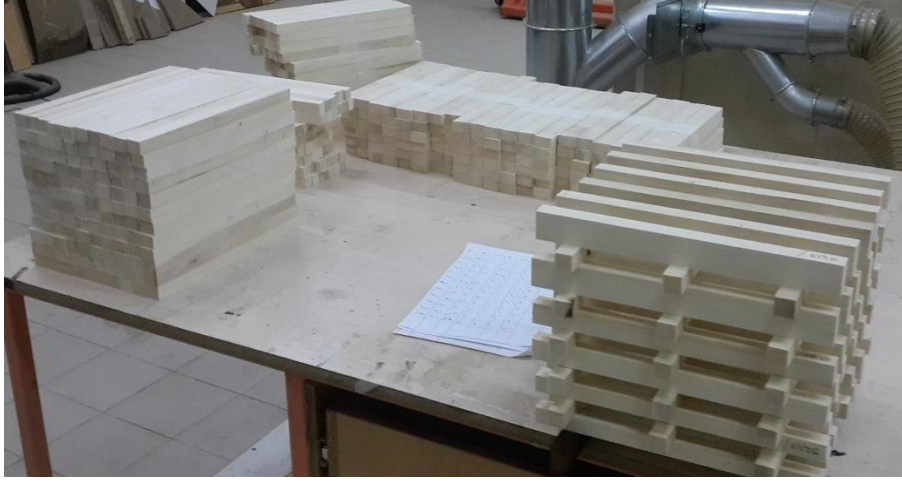
Şekil 4.2. Isıl işlem öncesi kaba ölçülerde kesilmiş örnekler.
