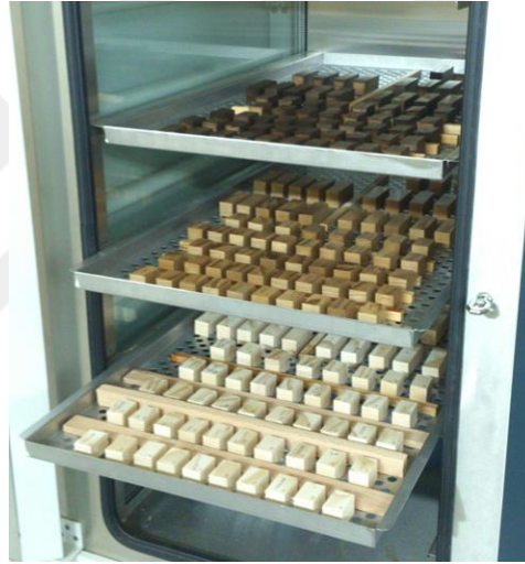
řekil 4.9. Örneklerin iklimlendirme dolabında kondisyonlanması.
