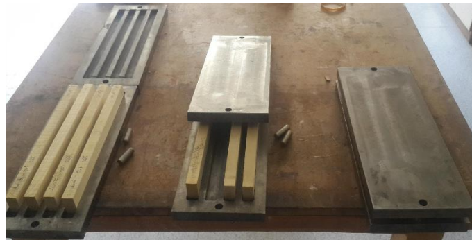
Şekil 4.6. Metal kalıplar ve örneklerin yerleşimi.
