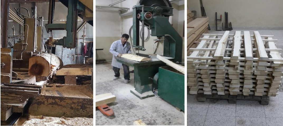
Şekil 4.1. Tomrukların biçilmesi ve lataların istifte kurutulması.
