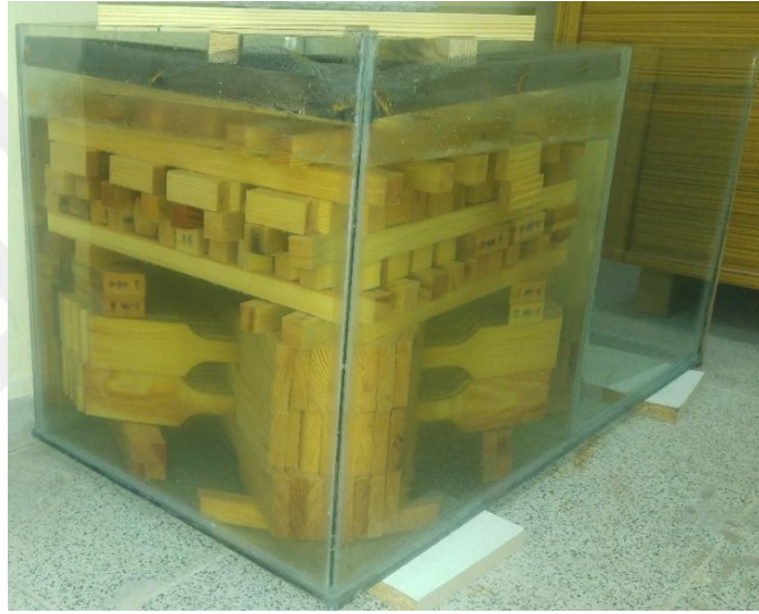
Şekil 6.7. Deney örneklerinin distile su içerisinde bekletilmesi.
