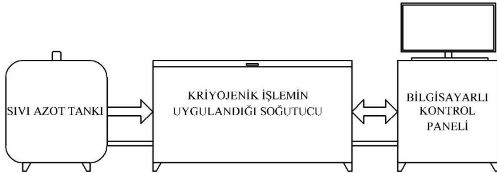
Şekil 4.3. Doğrudan soğutma prensibi ile çalışan sıfır altı işlem ekipmanı şematik gösterimi [49].
