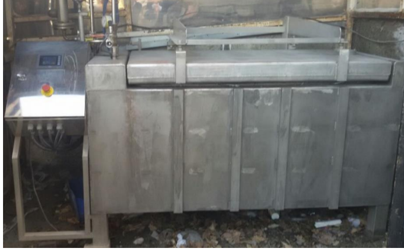
Şekil 6.1. Bilgisayar kontrollü, doğrudan soğutma metodu ile çalışan Kİ sistemi.
