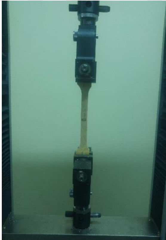
Şekil 6.15. Liflere paralel ÇD testi.
