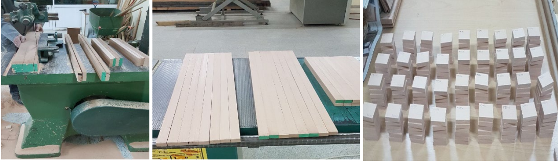
Şekil 4.3. Renk testi örneklerinin hazırlanması.
