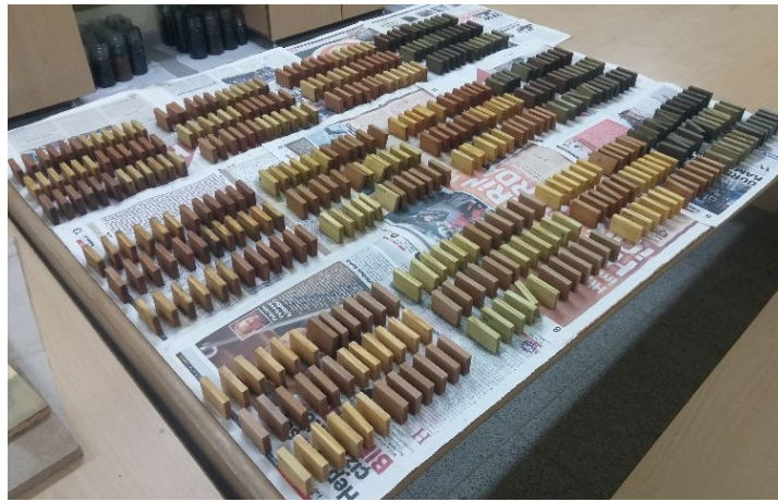
Şekil 4.8. Daldırma yöntemiyle empenye edilmiş örnekler.
