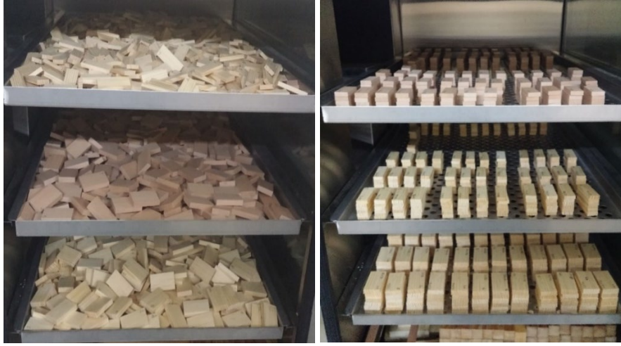
Şekil 4.5. Hazırlanan deney örneklerinin iklimlendirilmesi.
