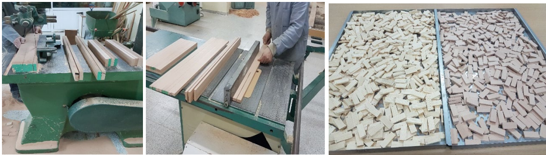
Şekil 4.4. Mantar çürüklük testi örneklerinin hazırlanması.
