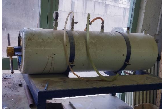
Şekil 4.7. Silindirik tank empenye düzeneği.
