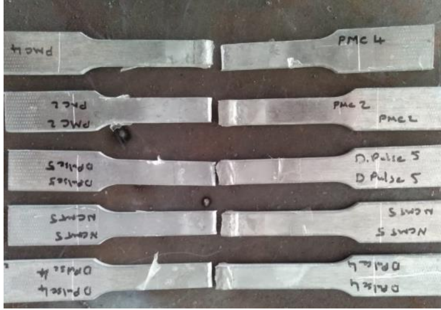
Şekil 6.1. Çekme testi uygulanarak kaynak dikişinden kopan numunelerin kopma biçimleri.
