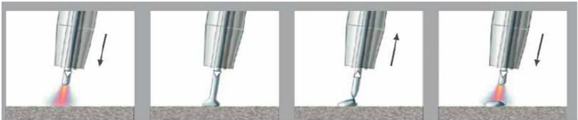
Şekil 4.25. Soğuk metal transfer yöntemi aşamaları (Kahraman, Gencer, Yolcu, Kahraman, & Dilbaz, 2018).
