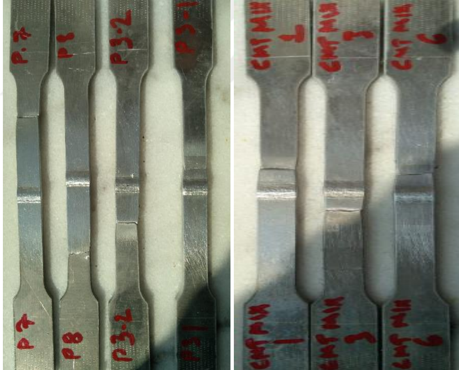
Şekil 6.1. Çekme testi uygulanarak kaynak dikişinden kopan numunelerin kopma biçimleri.
