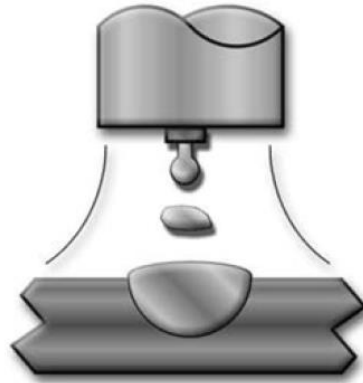
Şekil 4.19. Küresel transfer transfer modunda elektrodun kaynak banyosuna geçişi (Muzafferoğlu, 2008).
