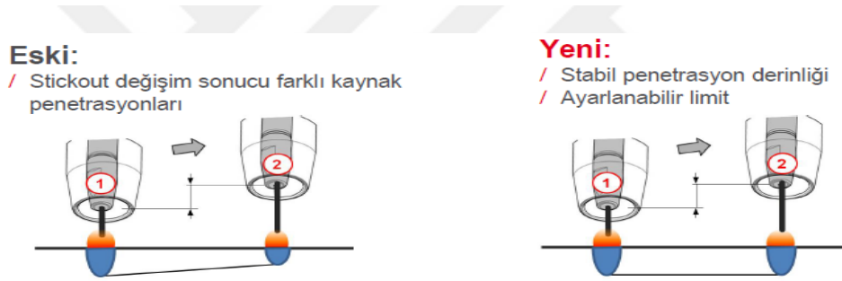
Şekil 4.27. Normal darbeli ve darbeli yüksek kontrollü ark parametrelerinin nüfuziyet görüntüsü (Fronius, 2016).
