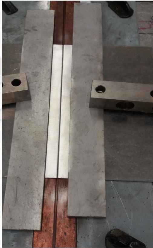
Şekil 5.2. Kaynaklı birleştirme yapılacak parçaların bakır altlık üzerine sabitlenmesi.
