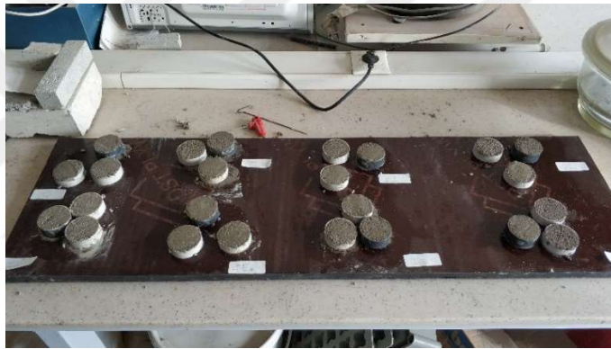
Şekil 3.15. Disk formunda taze harç numuneleri.
