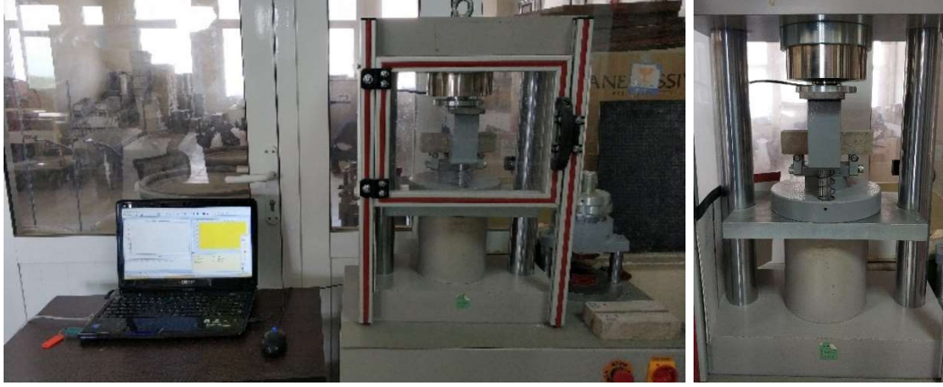
Şekil 3.23. Eğilmede çekme dayanımı deneyi yapılışı.
