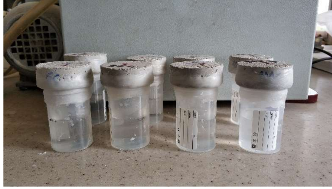
Şekil 3.17. Su buharı geçirgenlik deneyi için hazırlanan numuneler.
