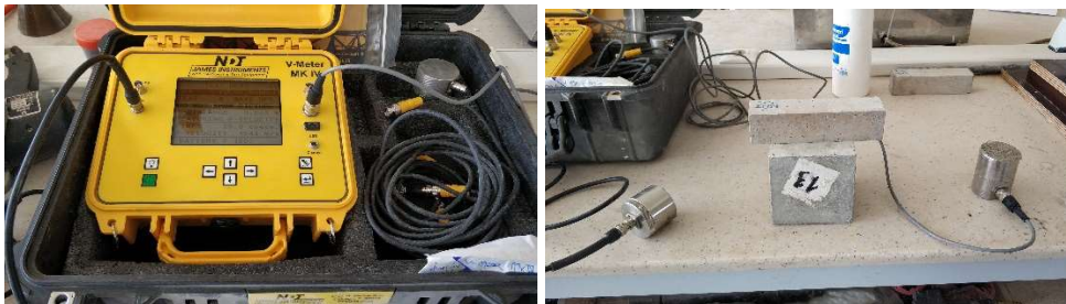
Őekil 3.21. Ultrases geiř hızı deney dzeneđi.
