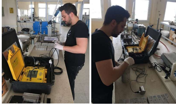
Şekil 3.22. Ultrases geçiş hızı deneyinin yapılışı.
