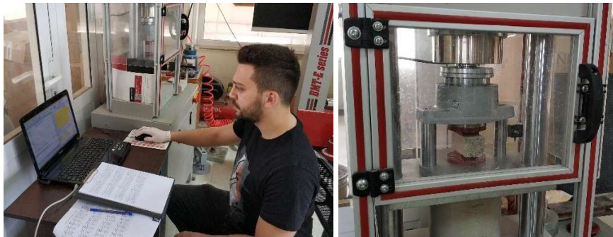
Şekil 3.24. Basınç dayanımı deneyi yapılışı.
