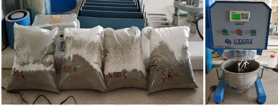
Şekil 3.5. Harç serilerinin hazırlanması ve kullanılan harç mikseri.
