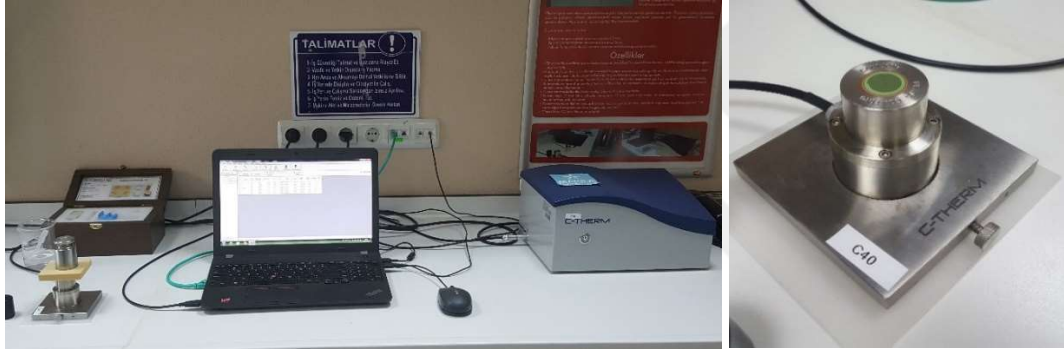
Şekil 3.20. Termal iletkenlik deney aleti ve ölçüm düzeneği.
