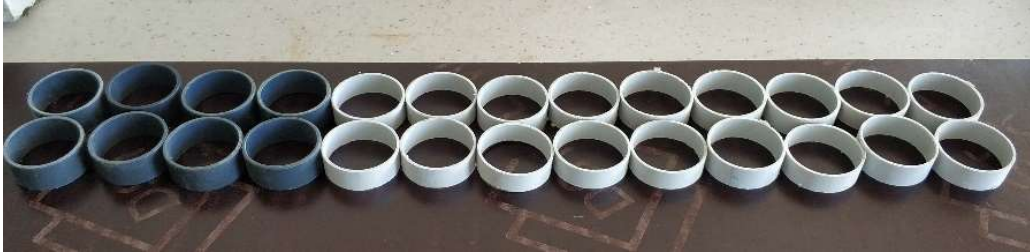
Şekil 3.14. Su buharı geçirgenliği ve termal iletkenlik deneyi için kullanılan disk kalıplar.
