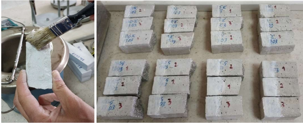
Şekil 3.12. Parafin kaplanarak deneye hazırlanan numuneler.
