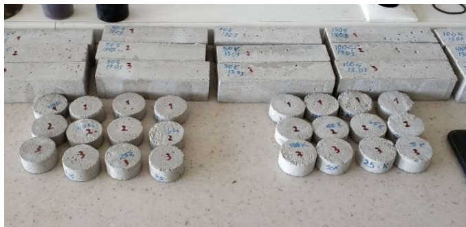
Şekil 3.16. Disk formunda sertleşmiş harç numuneleri.
