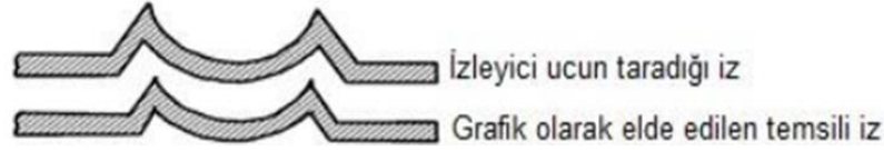
Şekil 3.14. İzleyici uçtan kaynaklanan ölçüm hatası [65].
