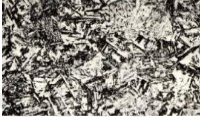
Şekil 2.7. Çökeltmeyle sertleştirilmiş paslanmaz çeliğin mikro yapısı [36].
