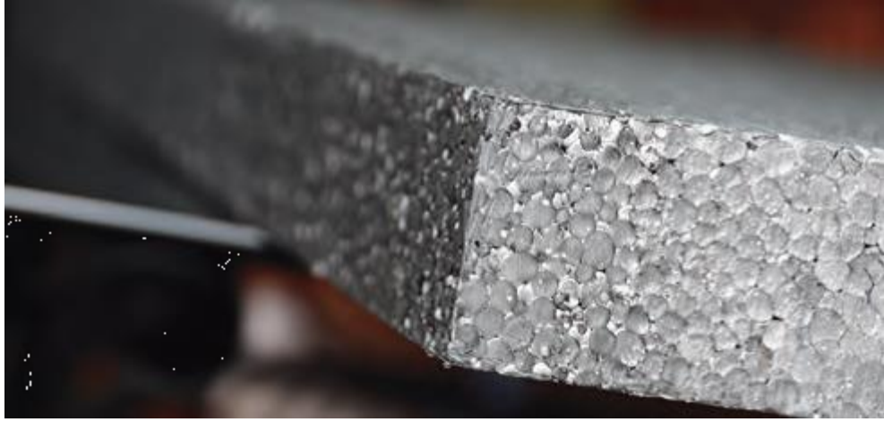
Şekil 3.7 EPS yalıtım malzemesinin yapısı.
