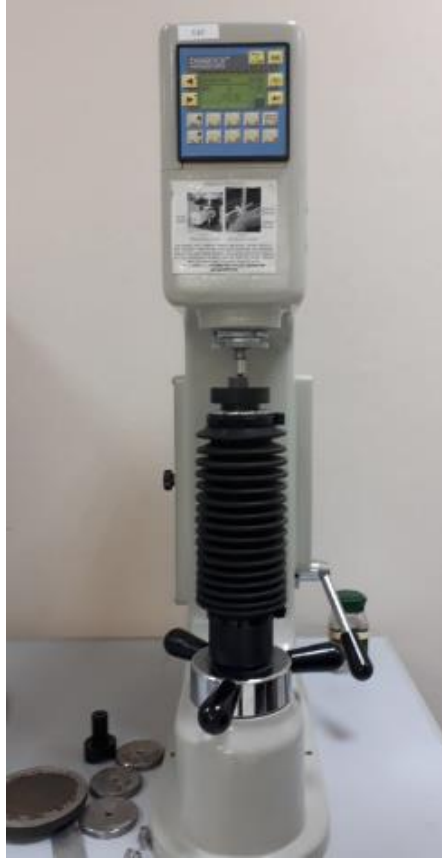
Şekil 4.6. Sertlik ölçme cihazı.
