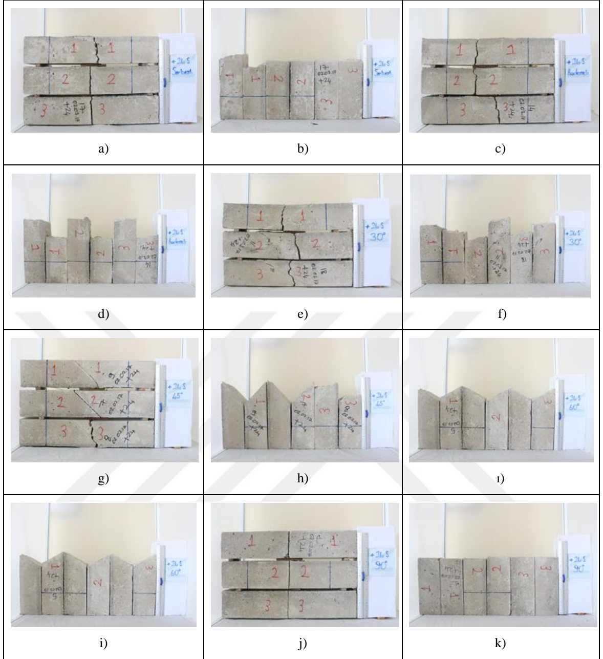
Şekil 4.10. +1440 dakikaya ait tüm birleşim geometrilerinin kırılma şekilleri a) Serbest döküm b) Serbest döküm c) Kademeli döküm d) Kademeli döküm e) 30 Derece açılı f) 30 Derece açılı g) 45 Derece açılı h) 45 Derece açılı i) 60 Derece açılı i) 60 Derece açılı j) 90 Derece açılı k) 90 Derece açılı.
