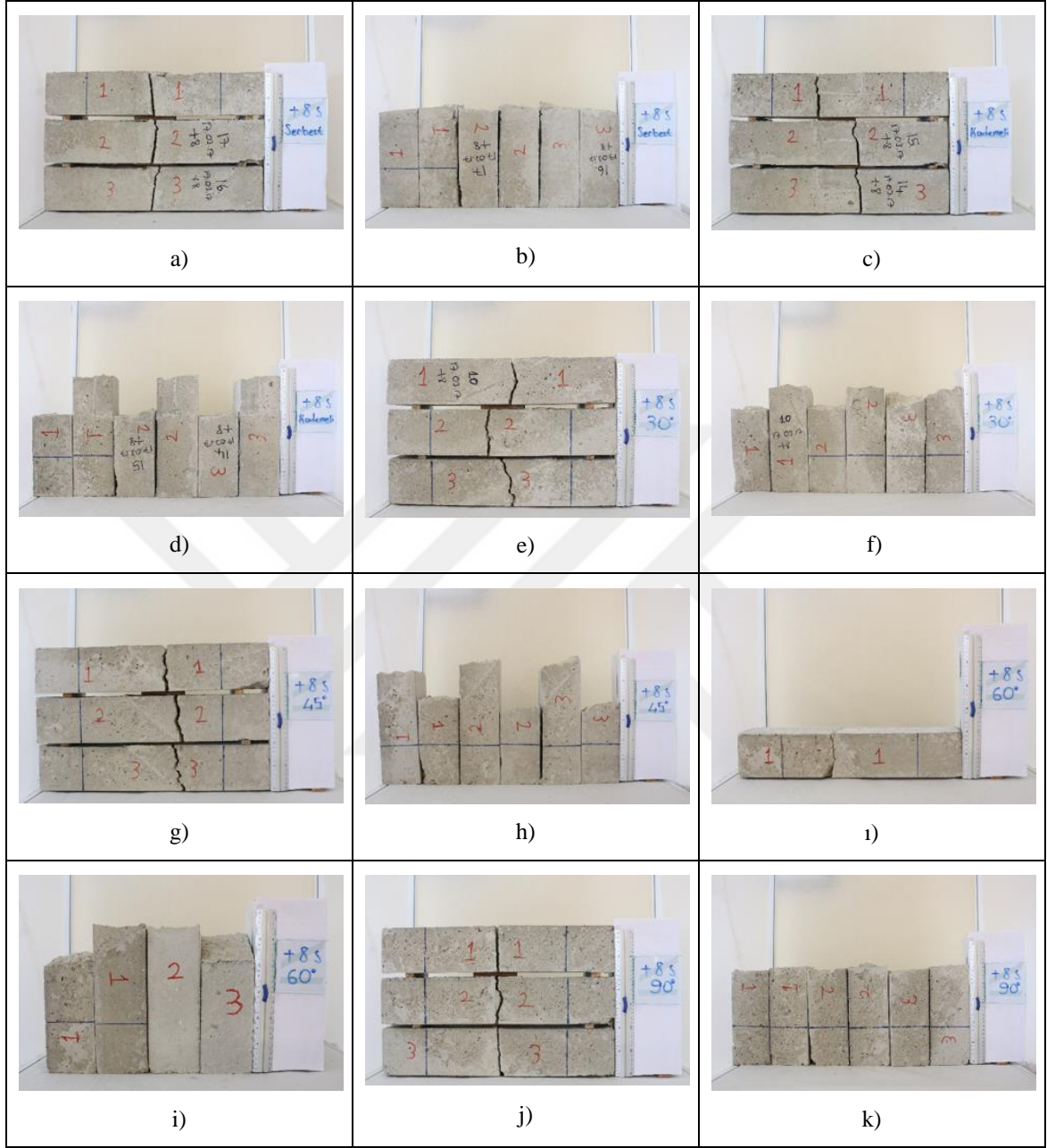
Şekil 7.6. +480 dakikaya ait tüm birleşim geometrilerinin kırılma şekilleri a) Serbest döküm b) Serbest döküm c) Kademeli döküm d) Kademeli döküm e) 30 Derece açılı f) 30 Derece açılı g) 45 Derece açılı h) 45 Derece açılı i) 60 Derece açılı j) 60 Derece açılı k) 90 Derece açılı.
