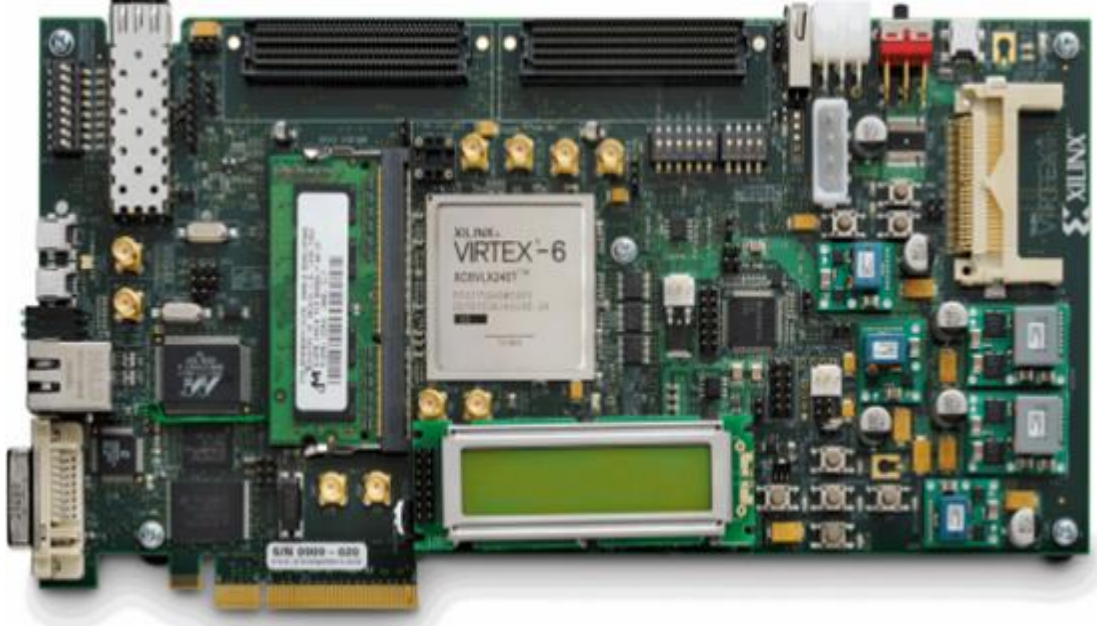
Şekil 2.7. Xilinx firmasının ürettiği Virtex-6 FPGA kartı.
