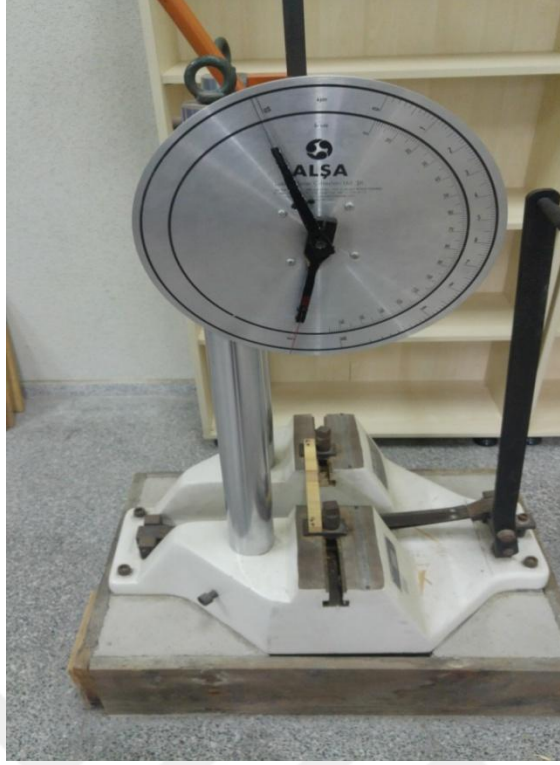
Şekil 2.17. Şok direnci deney görüntüsü.
