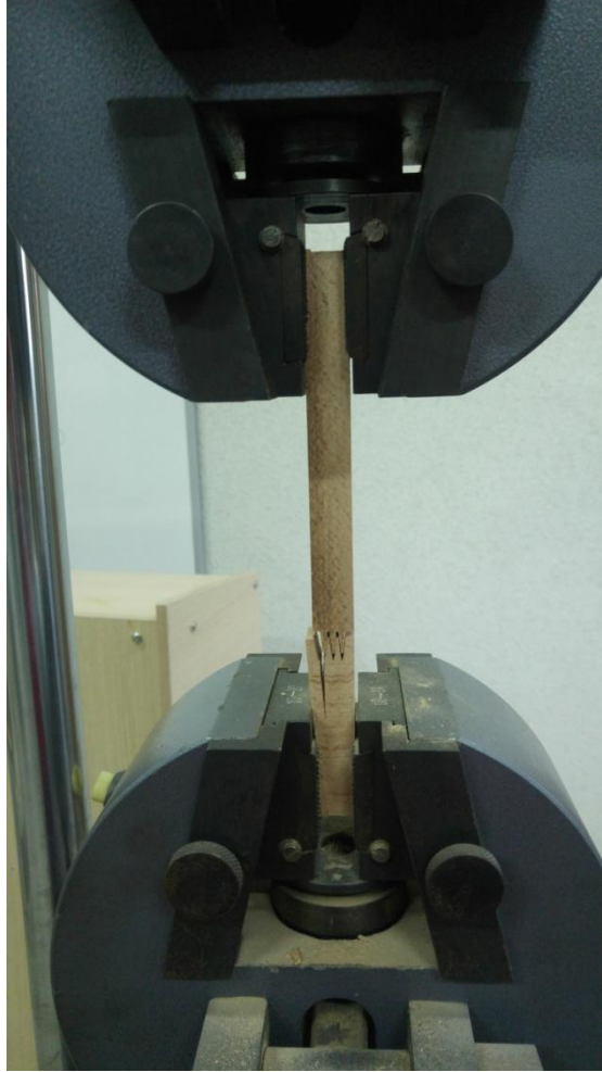
Şekil 3.1. Masif panel levhalarının çekme direnci sırasında kırılma görüntüsü.
