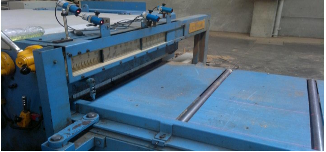
Şekil 2.4. Yan alma makinesi görünümü.
