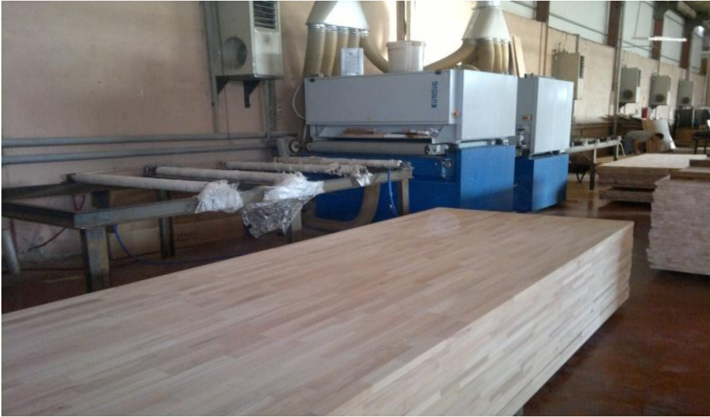
Şekil 2.11. Zımpara makinesi görünümü.
