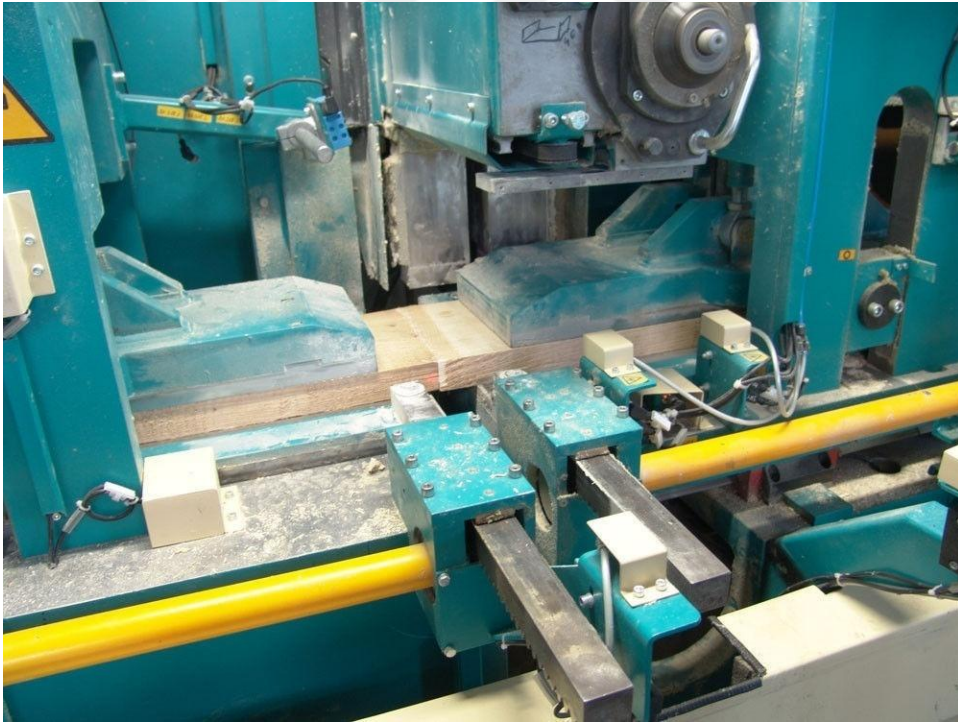
Şekil 2.8. Finger-joint makinesi görünümü.
