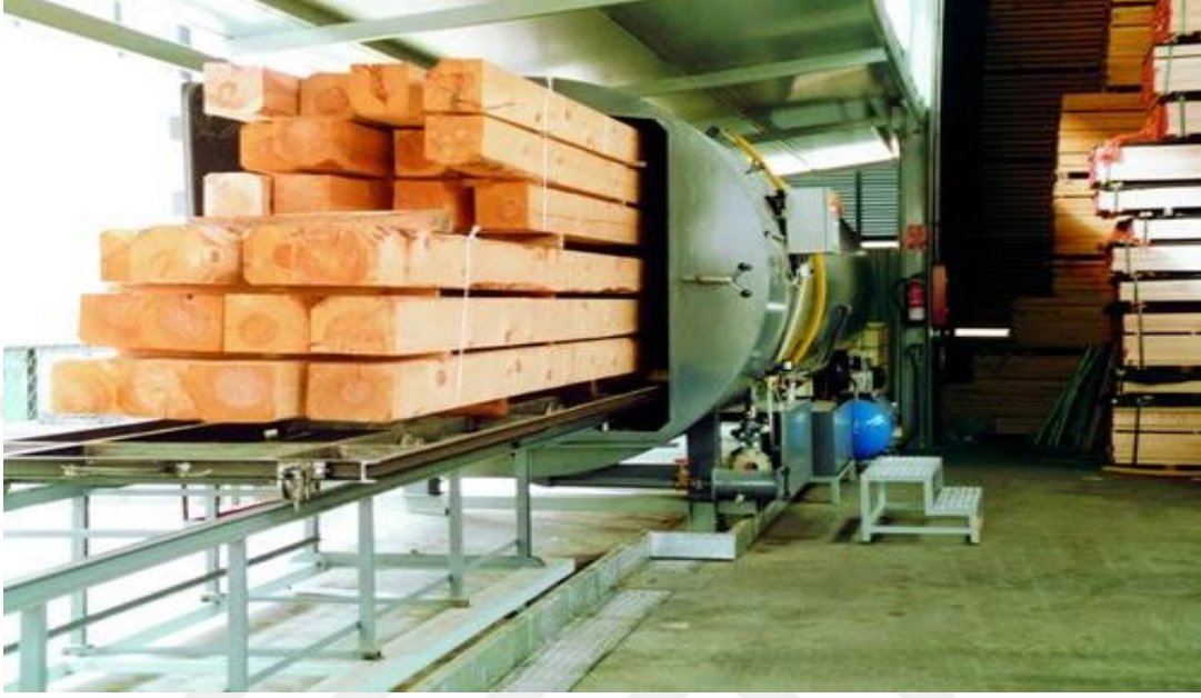
Şekil 1.12. Yüksek-frekans vakum kombinasyonlu kurutma fırını.
