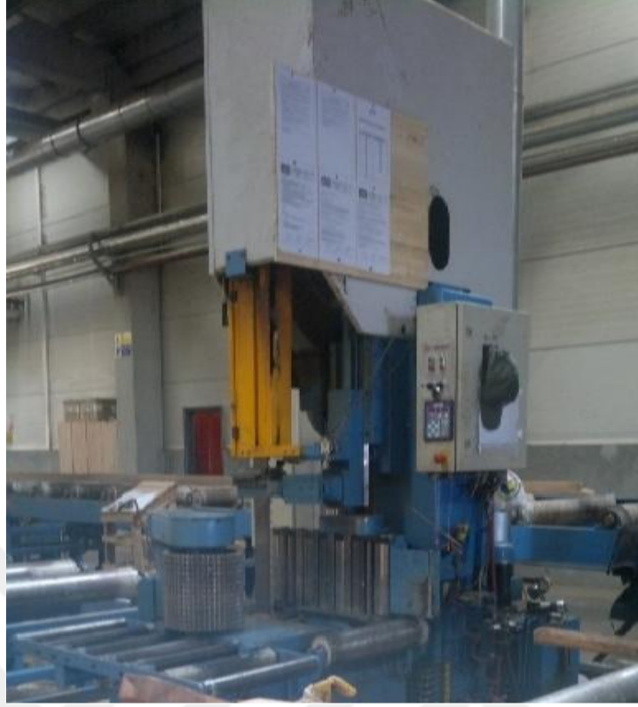
Şekil 2.3. 120 cm çapındaki markol (şerit testere) görünümü.
