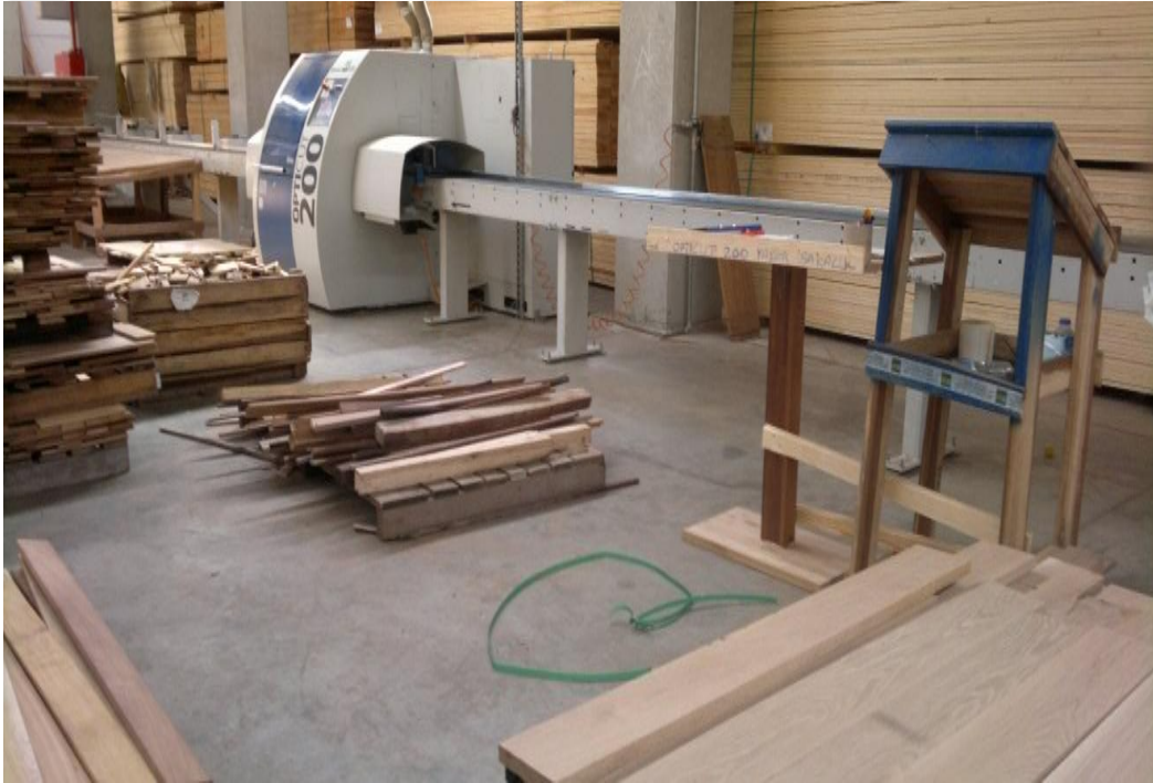
Şekil 2.7. Opti-Cut Makinesi görünümü.
