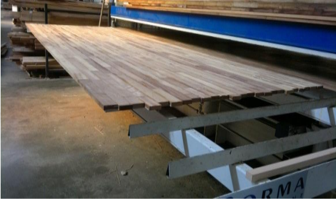
Şekil 2.10. Masif panel pres görünümü.
