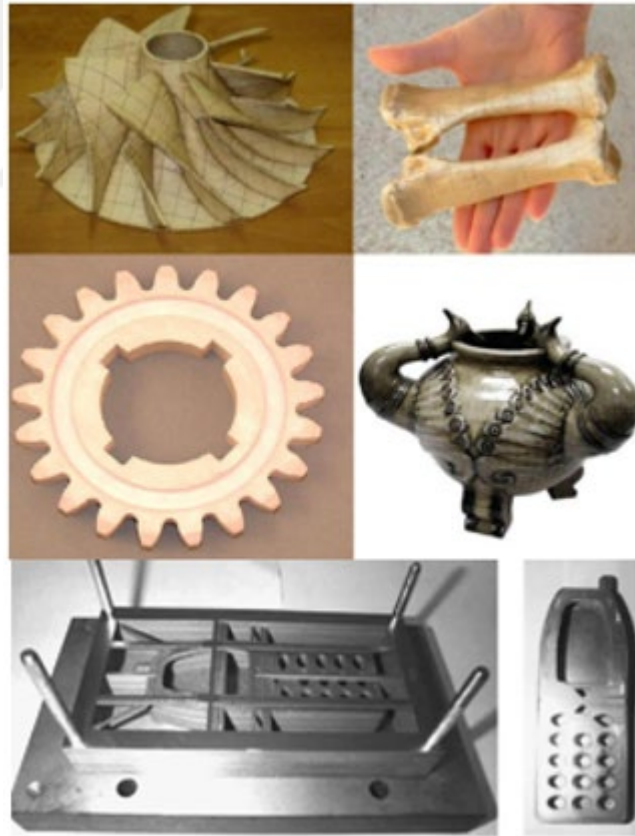
Şekil 3.11. Tabakalı nesne üretim tekniği örnek parçalar [53], [54].
