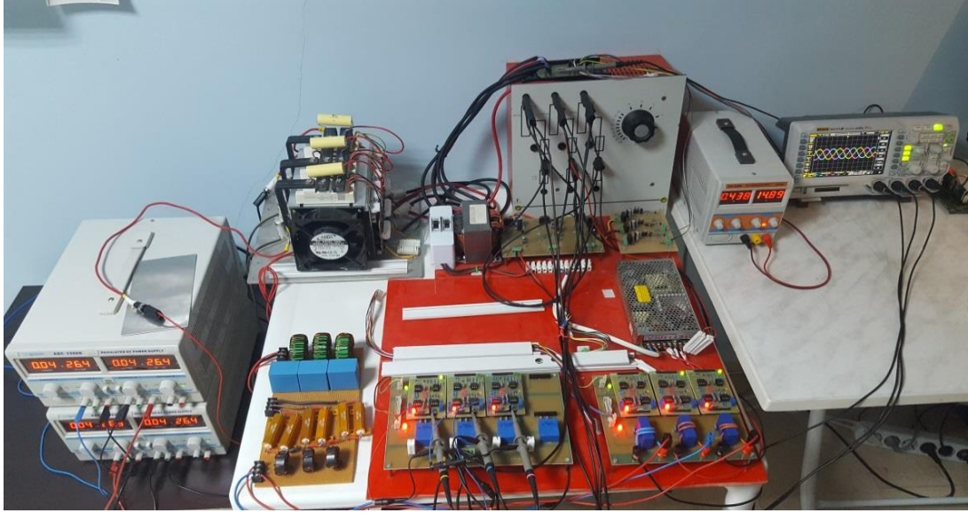
Şekil 5.1. Üç fazlı eviricinin deney düzeneği.
