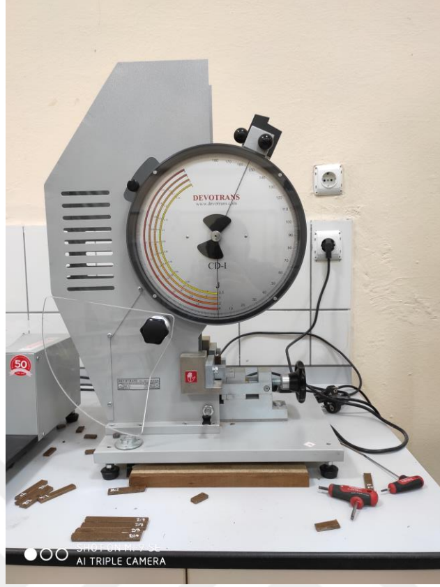
Şekil 3.11. Devotrans darbe test makinası.
