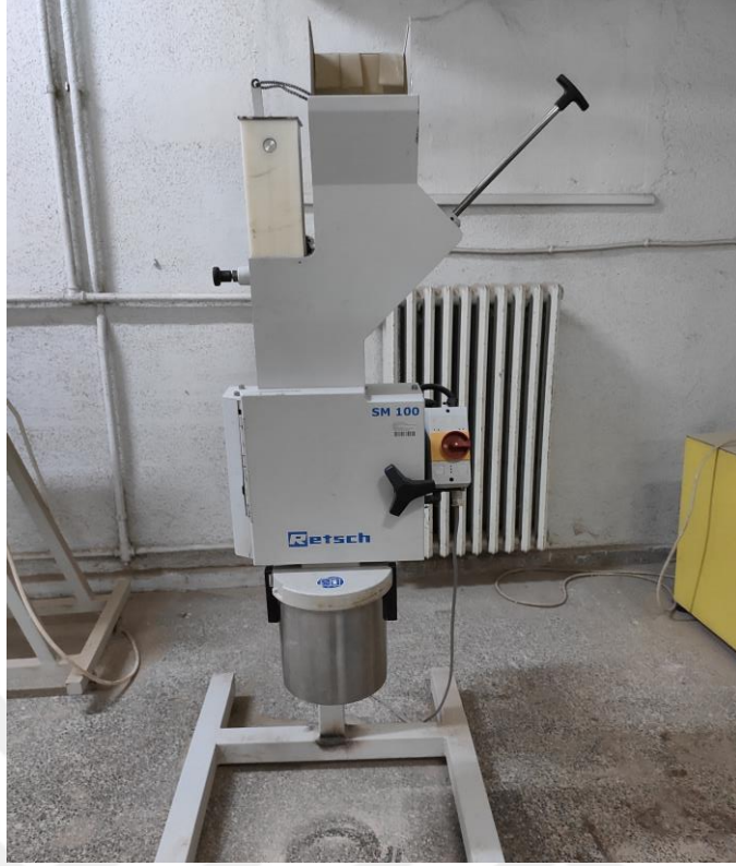
Şekil 3.1. Mısır saplarının öğütüldüğü Retsch SM100 öğütücü.
