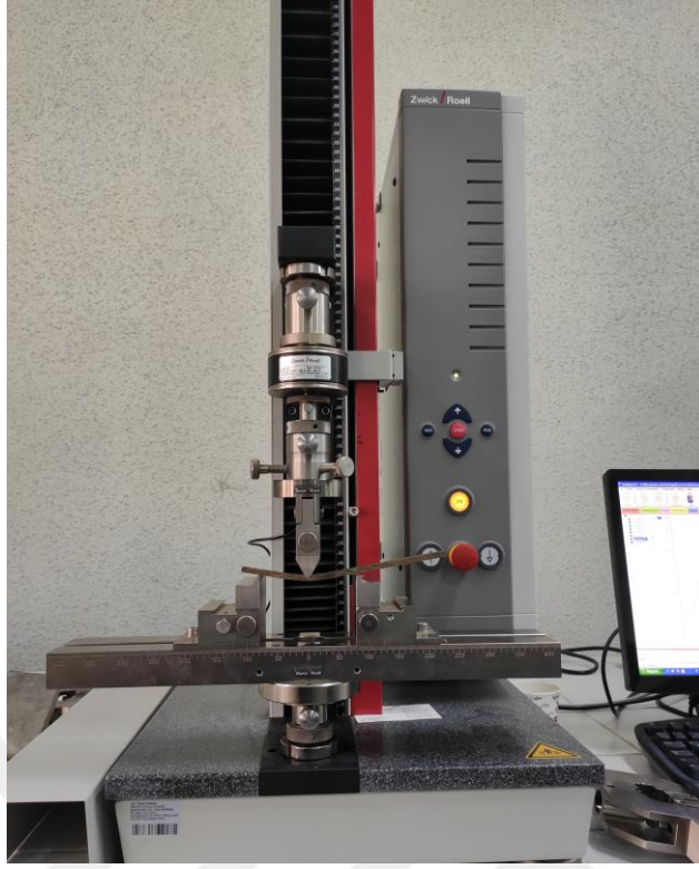
Şekil 3.9. Zwick/Roell Z1.0 test makinası ve eğilme testi.
