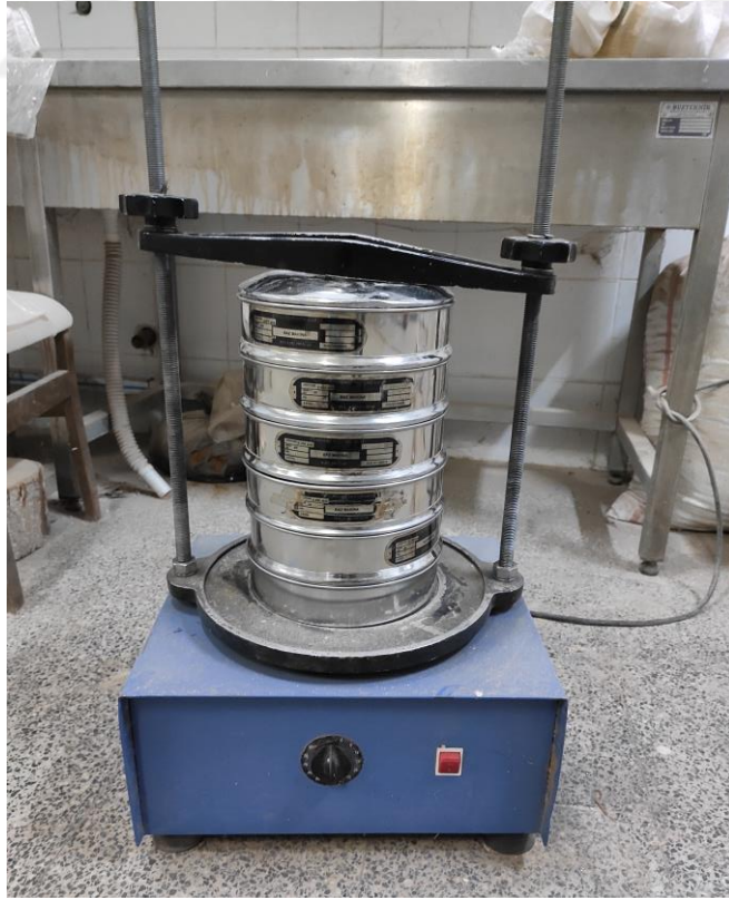
Şekil 3.2. Mısır saplarının elenmesi (Sarsak elek).
