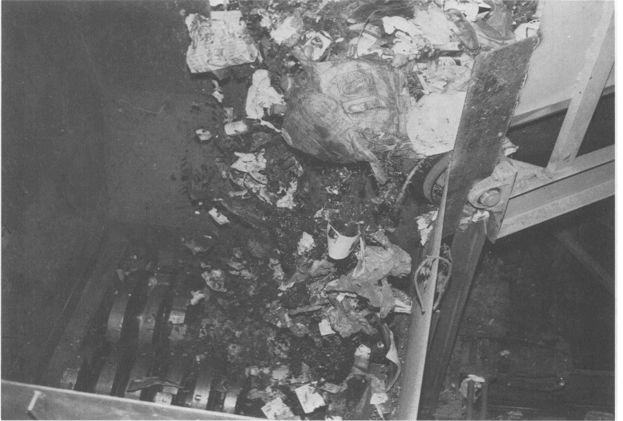
Şekil 1.12. Tip 2 Parçalama Makinesine beslenen tipik bir kentsel atığın akışı.
