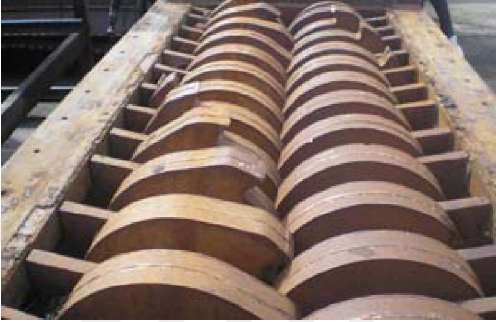
Şekil 1.8. LSHT parçalayıcının kesici mili.
