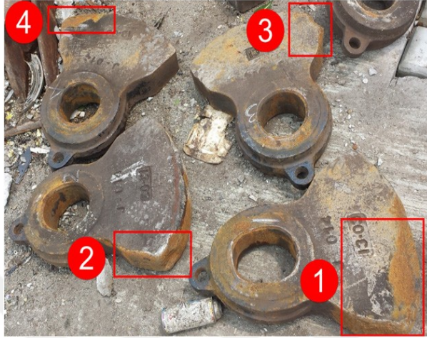
Şekil 2.2. Dört yıpranmış çekicinin fotoğrafı.
