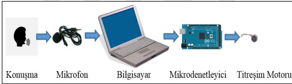
Şekil 3.1: Sistemin Çalışma Yapısı.
