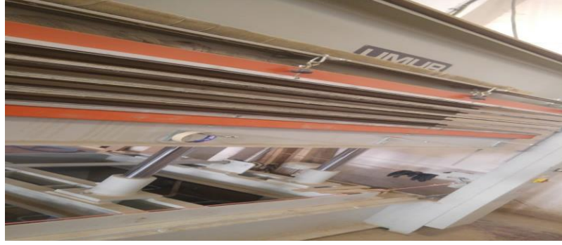
Şekil 1.8. Kanatların preslenmesi (Foto: Demiröz, 2019).
