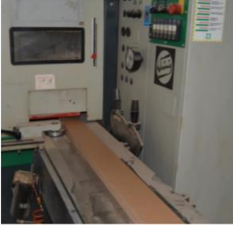
Şekil 1.11. Kasaların weinig makinasına girişi (a) ve çıkışı (b) (Bıçak ve Atar, 2017).
