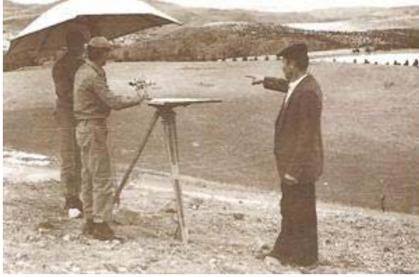
(1) Alıdat Olometrik Aleti İle Bütünleme Çalışması, 340 (2) Sayısal Topoğrafik Bütünleme Sistemi 341
