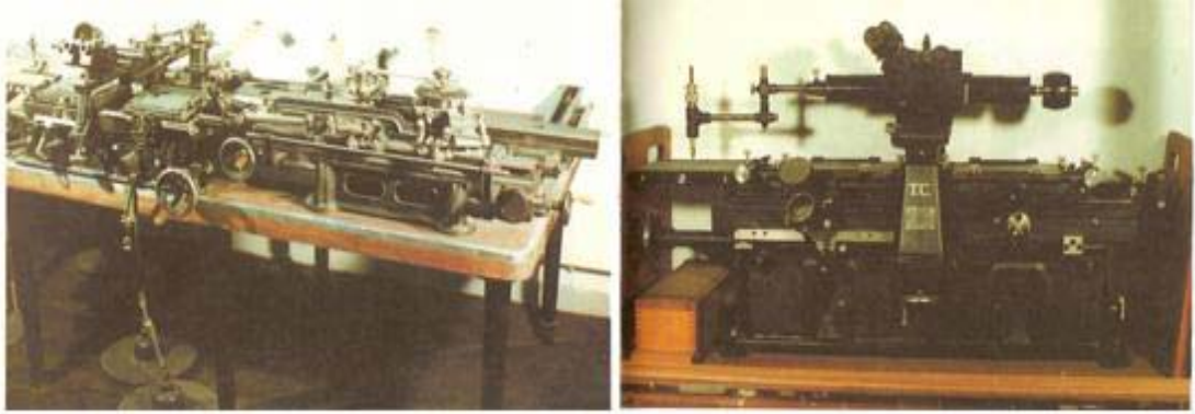
Hâlen Harita Genel Komutanlığı Müzesinde Sergilenen 1927 Yılında Satın Alınan Stereocomparateur ve Stereoautograph Aleti 103
