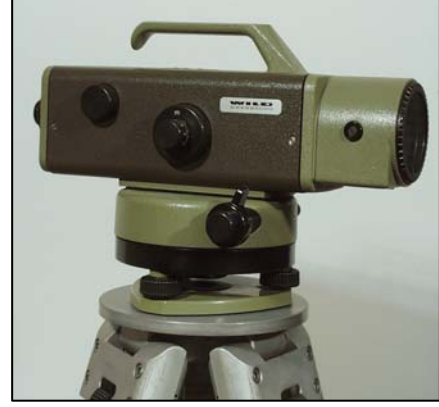
Nivelman Çalışmalarından Bir Görünüş ve Wild N3 Nivelman Aleti 199
