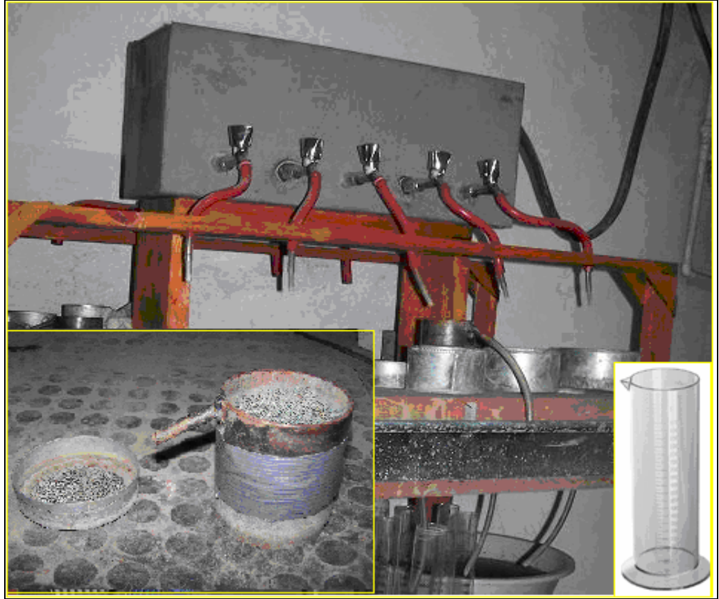
Şekil 3.19 Hidrolik iletkenlik (Permeametre seti)
