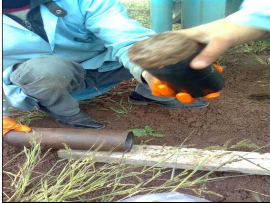
Şekil 3.10 Makineden ve örnekleme aparatından ayrılan plastik boru içerisindeki bozulmamış toprak örneği
