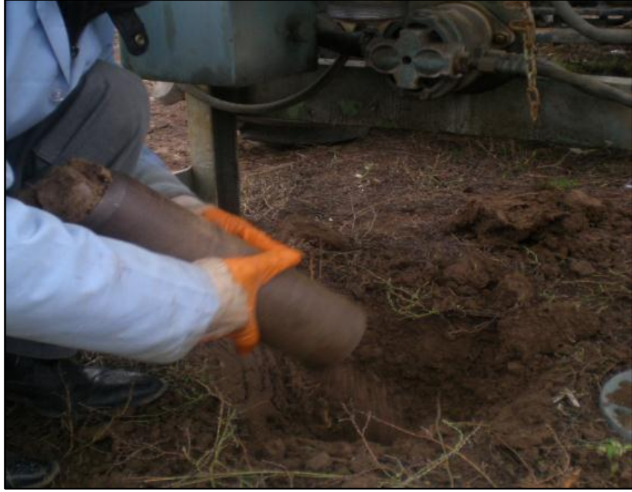
Şekil 3.9 İçerisinde plastik boru bulunan aparattan toprak örneği bulunan plastik borunun çıkarılması
