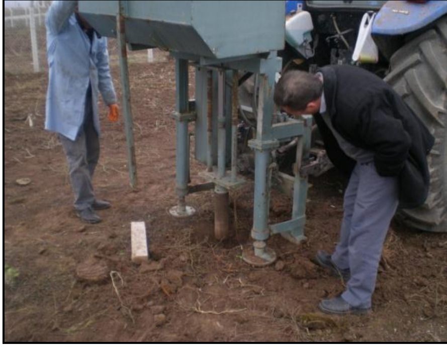
Şekil 3.7 Traktörün kuyruk milinden hareket alan ve içerisinde plastik boru bulunan aparatın toprak örneği ile topraktan çıkarılması
