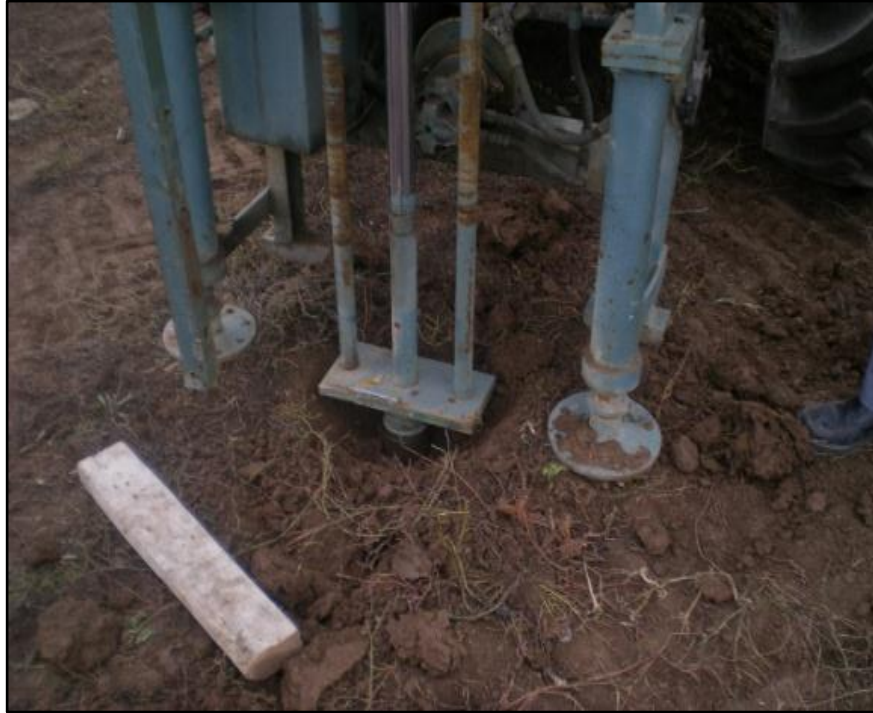
Şekil 3.6 Traktörün kuyruk milinden hareket alan ve içerisinde plastik boru bulunan aparatın toprağa girişi
