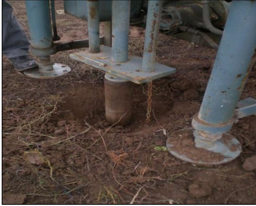
Şekil 3.5 Traktörün kuyruk milinden hareket alan ve içerisinde plastik boru bulunan aparatın toprağa girişi
