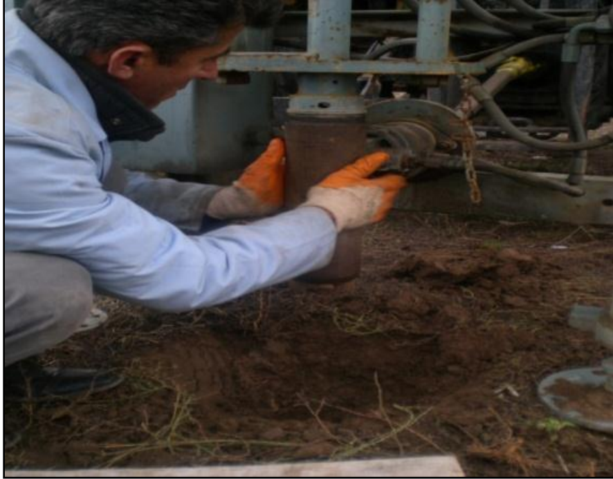
Şekil 3.8 Traktöre bağlı ve içerisindeki plastik boruda toprak örneği olan aparatın çıkarılması
