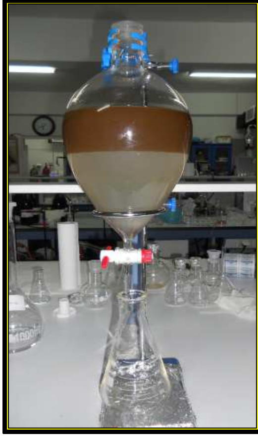
Şekil 3.18 TT sulu fazın ekstraksiyon işlemi
