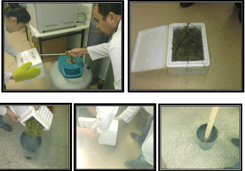
Şekil 3. 5 Karayosunlarının sıvı azotla parçalanma işlemi
