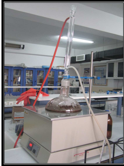
Şekil 3.16 TT sulu fazın geri soğutucu altında kaynatılması işlemi
