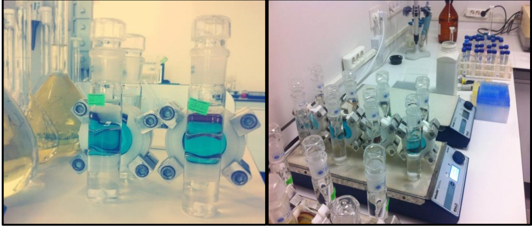
řekil 3.3 PİİM ekstraksiyon hcrelerinin besleme fazında bulunan Co(II)'nin sıyırma fazına tařınım sreci
