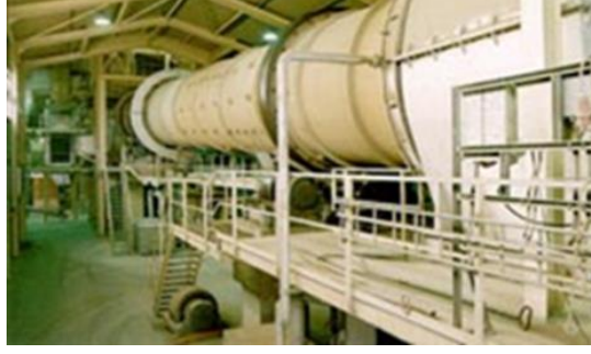
Şekil 1.9. Amerikan prosesinin gerçekleştiği döner fırınlar
