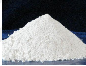
Şekil 1.6. ZnO'nun toz haldeki görünümü
