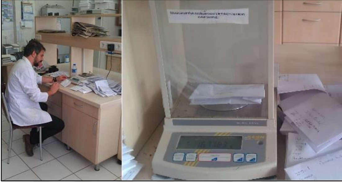
Şekil 4.8 Örneklerin hassas terazi vasıtasıyla hava kuru ağırlıklarının ölçülmesi
