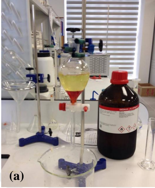
Şekil 3.1. (a) Stiren ve (b) metakrilik asit monomerlerinden inhibitörlerin uzaklaştırılması işlemleri
