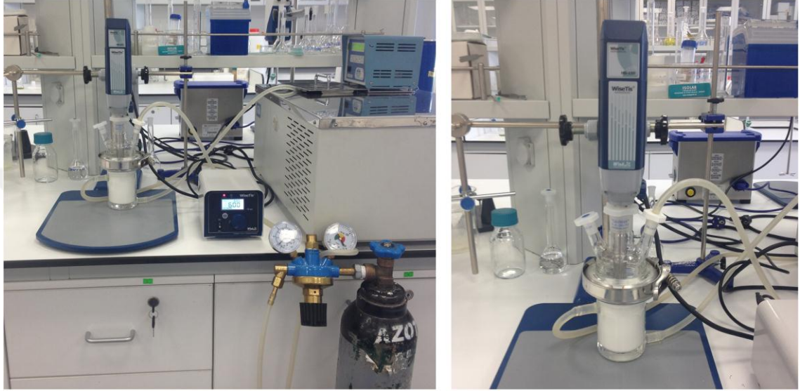
Şekil 3.2. Nanokapsül sentez düzeneği
