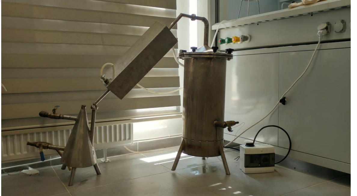
Şekil 3.1 Meyve posalarını kaynatma işlemi için kullanılan destilasyon düzeneği
