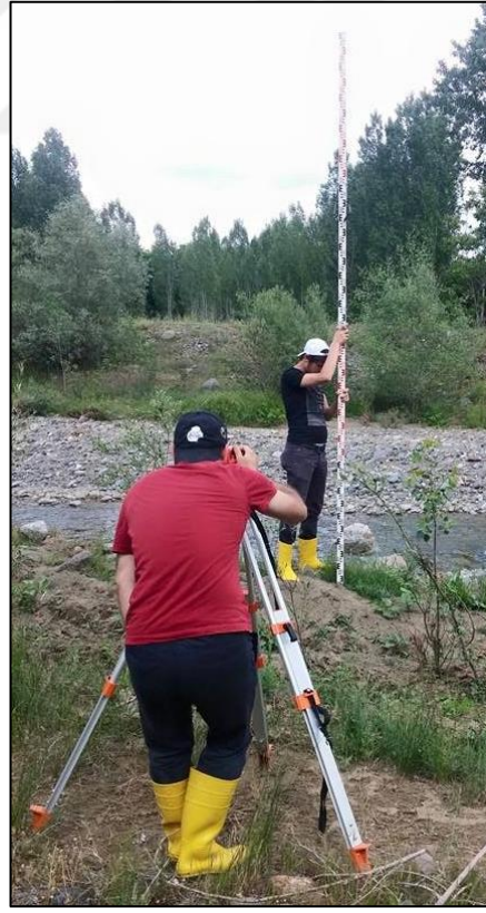
Őekil 3.12 En kesitin belirlenme çalışması
