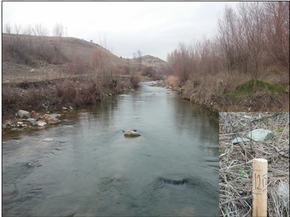
Şekil 3.13 Su örnekleme noktalarının sabit kazıklar ile işaretlenmesi
