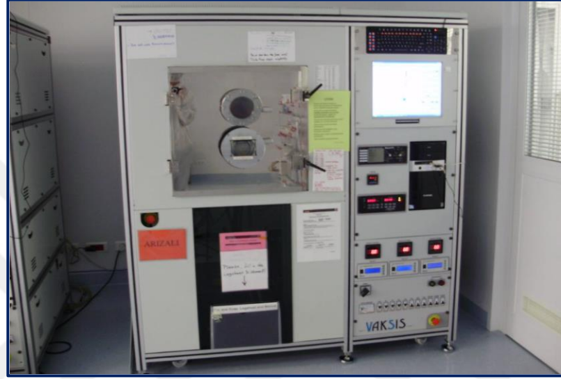
Şekil 3.4 VAKSIS (PVD Vapor-3S) Termal Buharlaştırma Sistemi (UNAM-izniyle)
