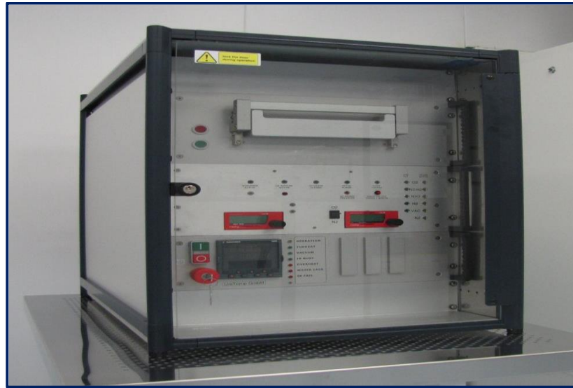
Şekil 3.5 ATV-Hızlı Isıl Tavlama Sistemi (UNAM'ın izniyle)
