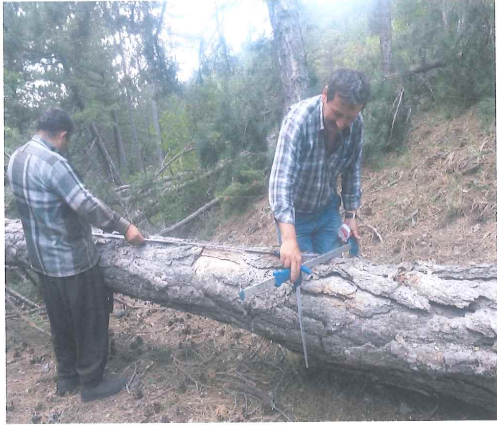
Şekil 2.2 Kesilen ağaçlar üzerinde gerçekleştirilen çap ölçümleri
