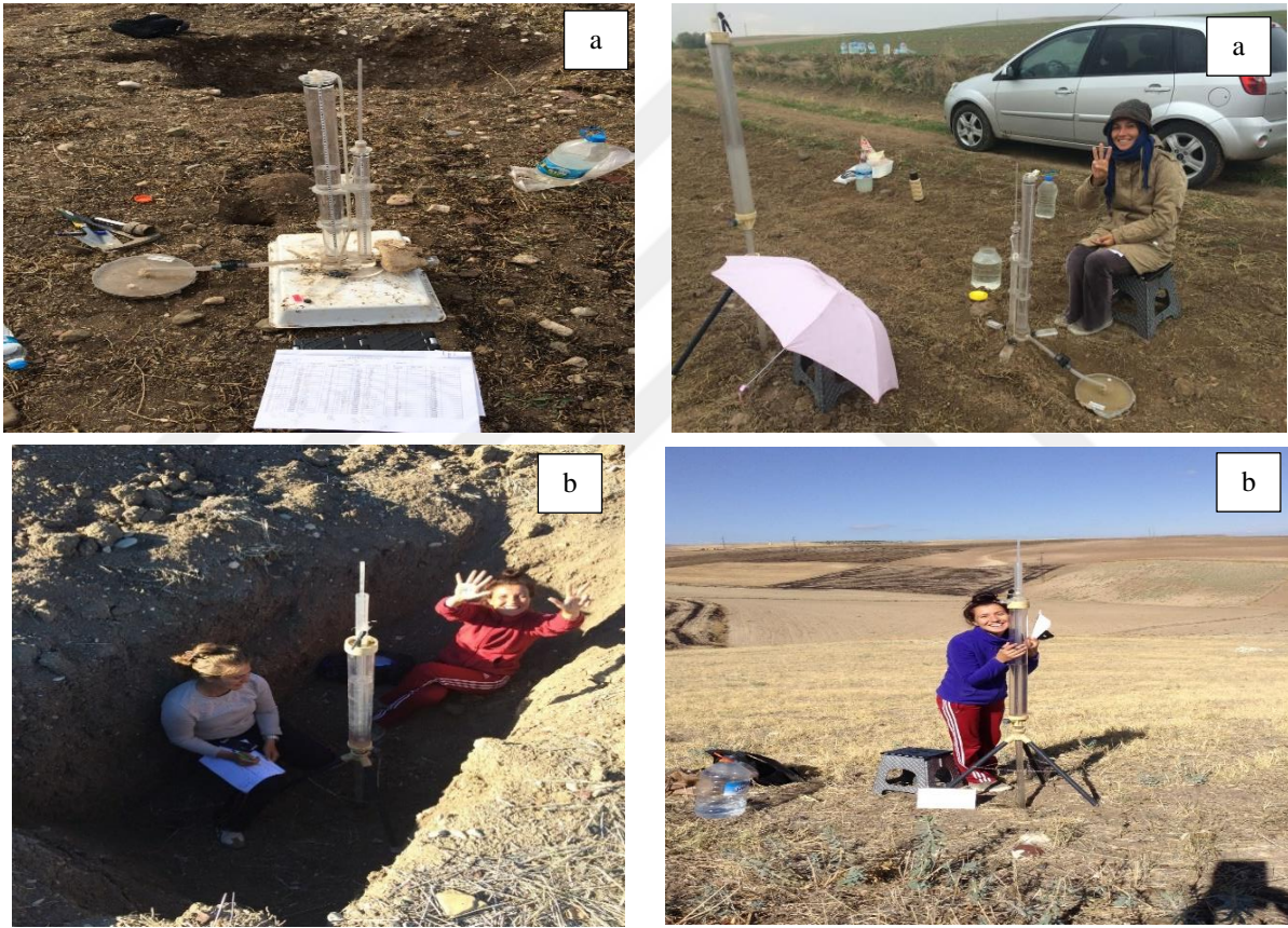
Şekil 3.7 Arazide yapılan hidrolik iletkenlik (b) ve infiltrasyon testleri (a)
