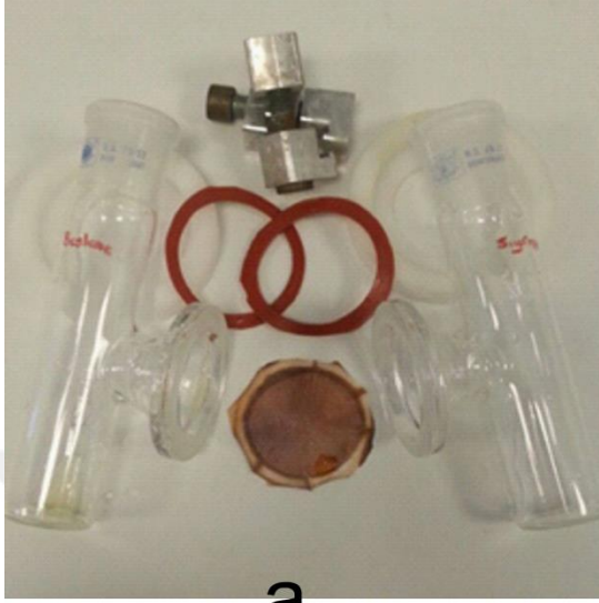
Şekil 3.2 PI-AKM ekstraksiyon hücresinin bileşenleri (a) ve Cr(VI) taşınım deneyleri süreci (b)
