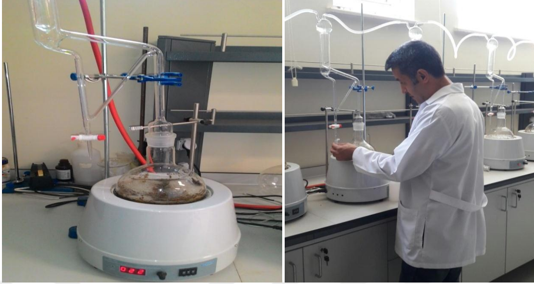
Şekil 3.7 Clevenger cihazı ve uçucu yağ çıkarılması
