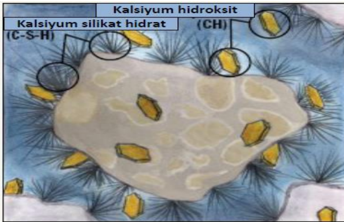
Şekil 1.18 Sertleşme sürecinde olan betonun C-S-H ve CH oluşumu (Kosmatha et al 2006)
