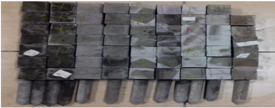
Şekil 2.8 Kalıptan çıkarılmış GO-Beton harç örnekleri
