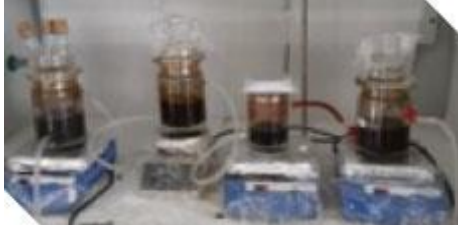
Şekil 2.3 Grafitten Hummers Yöntemi ile sentezlenen GO sentezine ait deney sistemi
