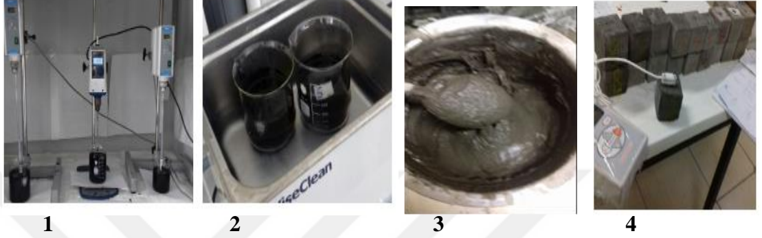
Şekil 2.7 GO-Beton harç deneylerine ait görüntüler ( 1- Grafen oksit-Su karışımı, 2- Grafen oksit ultrasonik etki, 3- Grafen oksit çimento harç, 4- 5'cm lik beton harç KD2PRO ölçümleri)
