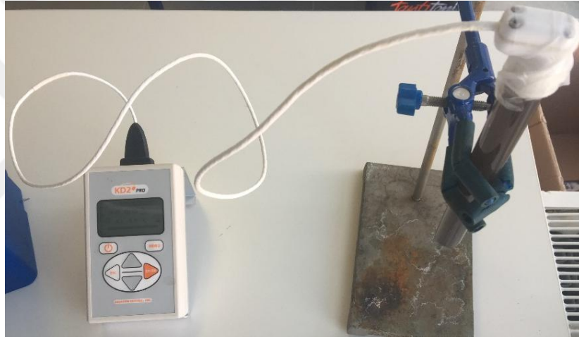
Şekil 3.2 KD2 Pro cihazı ile termal iletkenlik ölçümü
