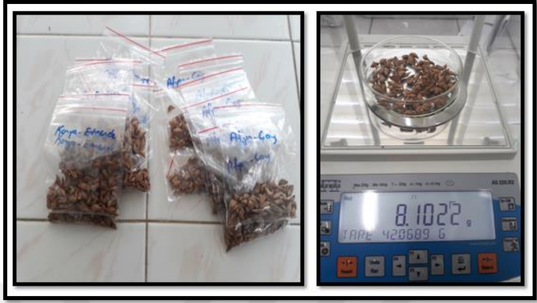
Şekil 14. Saf tohumların 100'erli gruplar halinde ayrılarak hassas terazide tartılması Çalışmada kullanılan her orijinin 1000 dane ağırlıkları Şekil 3' de verilen 1000 dane ağırlığı hesabı formülü ile hesaplanmıştır (Çizelge 3). Orijinlerin 1000 dane ağırlıklarının grafiksel durumu ise Şekil 15' de gösterilmiştir.
