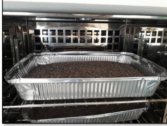
Şekil 6. Sterilizasyon için Etüv içerisinde bekletilen kumlar
