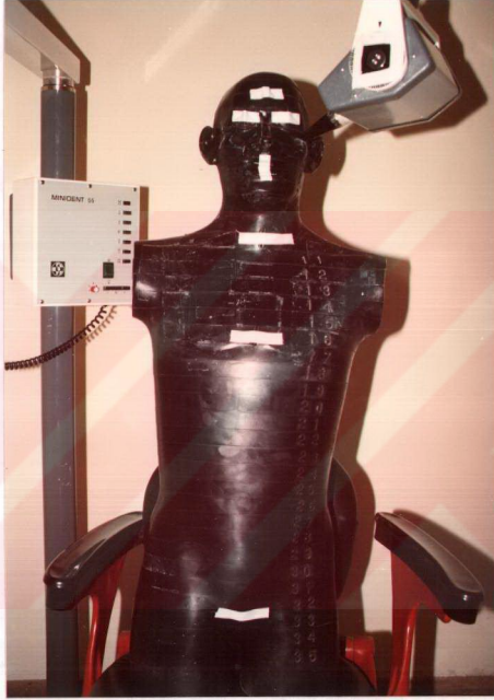
Resim 2.17: Kısa Konlu Cihazın Fantoma Uygulanışı.
