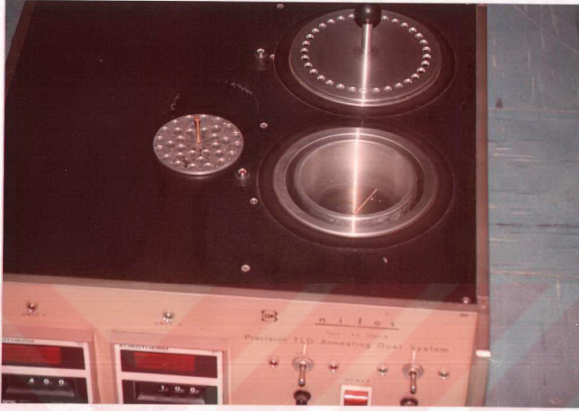
Resim 2.15; Nifos, TLD Annealing Dual System'e TLD'lerin Yerleştirilmesi.
