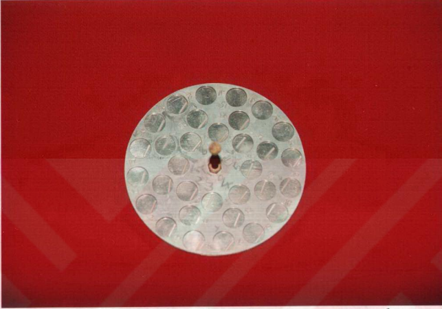
Resim 2.10; TLD.100 Dozimetrelerinin Fırınlama Esnasında Yerleştirildikleri Aliminyum Kab.
