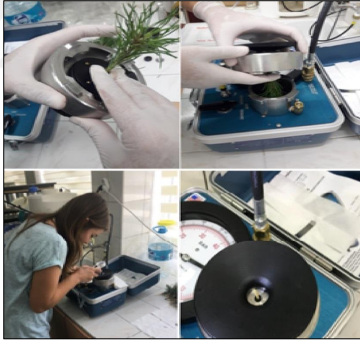
Şekil 4.14 Fidanlarda su potansiyeli ölçümü
