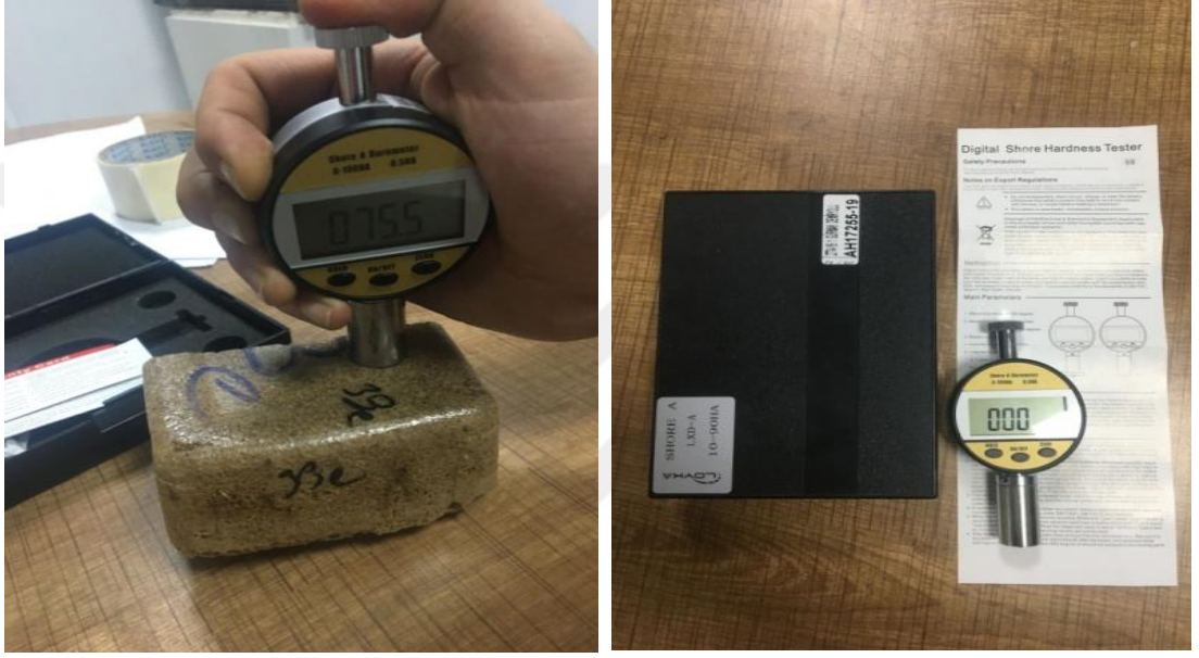
Şekil 3.10 Shore A cihazı ve sertlik ölçümü
