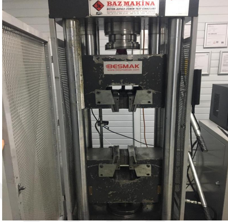
Şekil 3.3 Basma işleminde kullanılan BZ 001/60-OT-XC test cihazı
