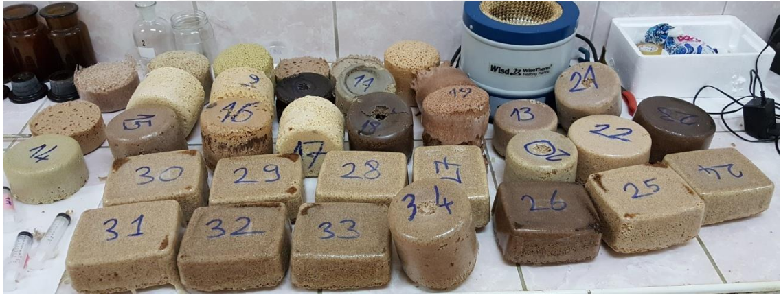
Şekil 3.1 Elde edilen bazı polimerik kompozit malzemeler
