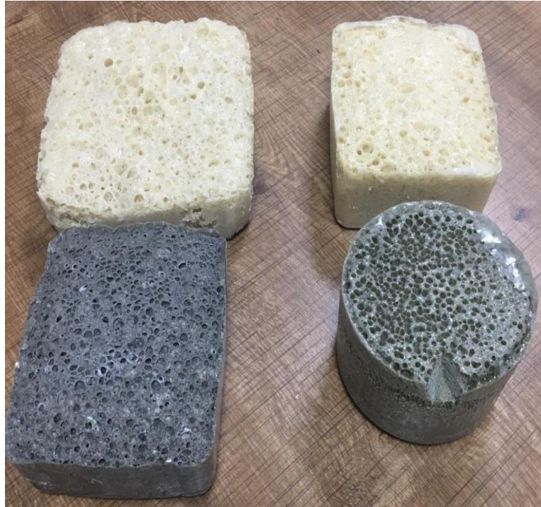
Şekil 3.2 Basma dayanımı öncesi kompozit malzemeler
