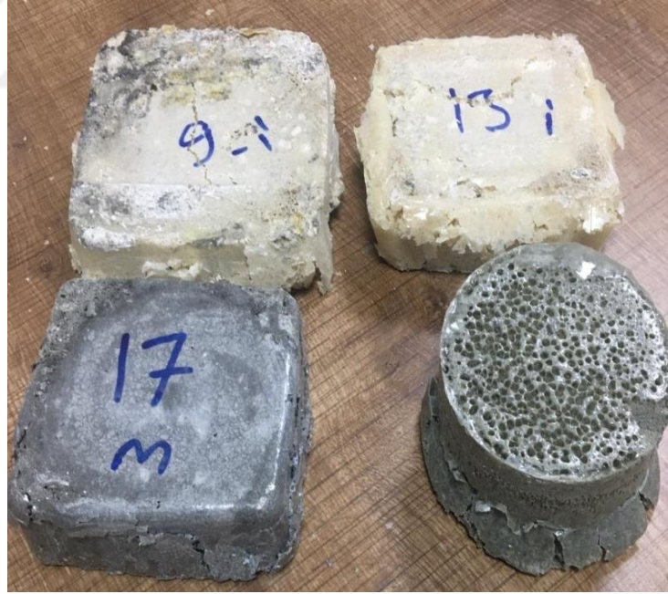
Şekil 3.4 Basma dayanımı sonrası kompozit malzemeler
