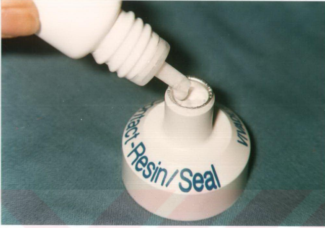
Resim 3: Likidin kristalize kaba damlatılması.
