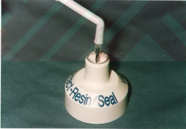
Resim 4: Fırça ile likid ve katalizörün karıştırılması.
