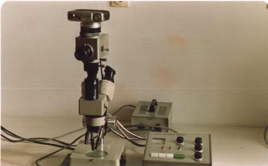
Resim 5: Modellerin incelemelerinin yapıldığı kamera bağlantılı stereomikroskop
