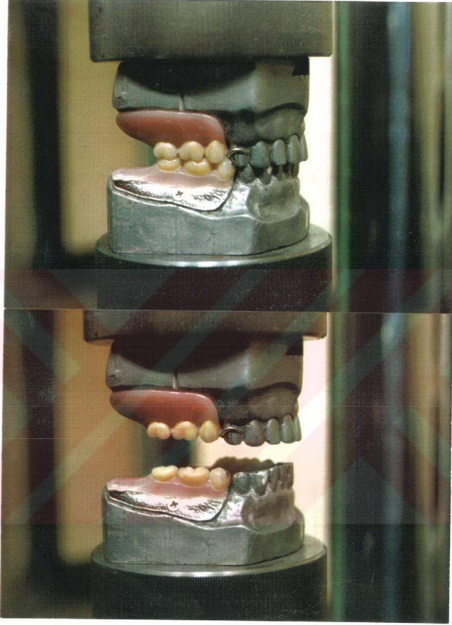
Resim 3.17. Programlanan koşullarda test protezlerine açma-kapama hareketi yaptırılırken.
