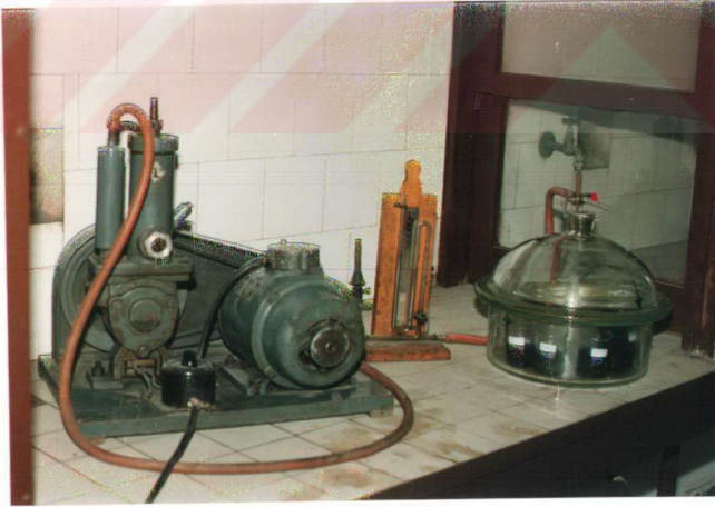
Resim 7: Vakum pompası ve örneklerin yerleştirildiği desikatör
