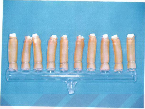
Resim 2.9: Boya sızıntısı deneyi için hazırlanan cam sistem.
