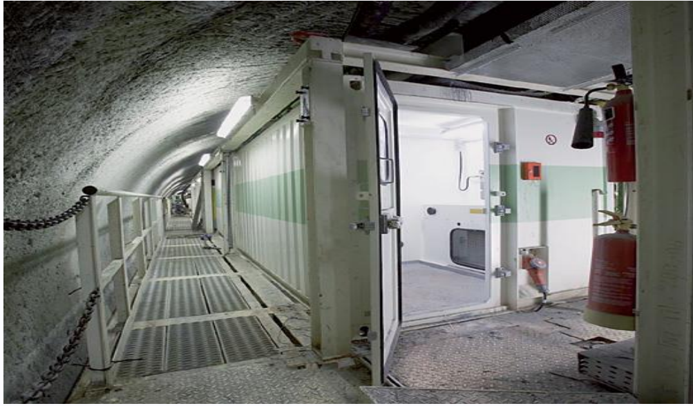
Şekil 11 Bir yaşam odasının maden içinde yerleştirilmiş şekli 47
