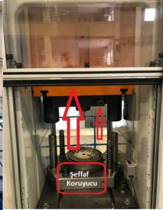
Şekil 6 Mekanik Pres üzerindeki şeffaf koruyucu
